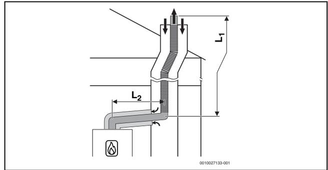
Bild 14 Flexible Abgasführung nach C<sub>93x</sub> im Schacht und konzentrische Luft-Abgas-Führung im Aufstellraum
