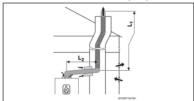
Bild 17 Flexible Abgasführung im Schacht nach B<sub>23p</sub>/B<sub>53p</sub> mit raumluftabhängiger Luftzufuhr am Gerät und konzentrischem Verbindungsstück zwischen Aufstellraum und Schacht
