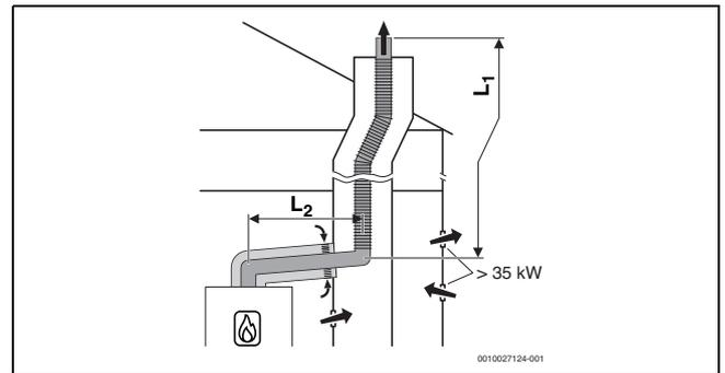
Bild 19 Flexible Abgasführung im Schacht nach B<sub>33</sub> mit raumluftabhängiger Luftzufuhr über die konzentrische Luft-Abgas-Führung im Aufstellraum
