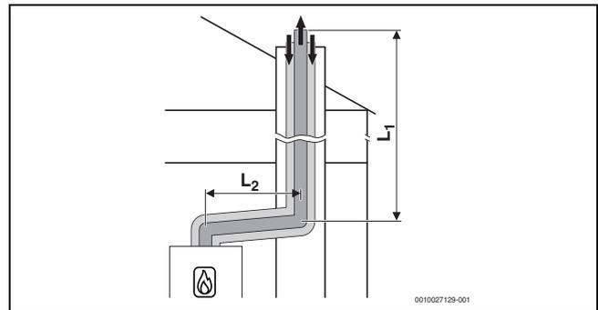
Bild 8 Konzentrische Luft-Abgas-Führung nach C<sub>33x</sub> im Schacht
