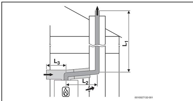
Bild 10 Starre Abgasführung nach C<sub>53x</sub> im Schacht und Luft-Abgas-Führung mit separater Luftzufuhr und konzentrischer Abgasableitung im Aufstellraum
