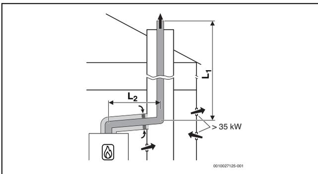
Bild 18 Starre Abgasführung im Schacht nach B<sub>33</sub> mit raumluftabhängiger Luftzufuhr über die konzentrische Luft-Abgas-Führung im Aufstellraum
