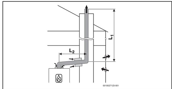
Bild 16 Starre Abgasführung im Schacht nach B<sub>23p</sub>/B<sub>53p</sub> mit raumluftabhängiger Luftzufuhr am Gerät und konzentrischem Verbindungsstück zwischen Aufstellraum und Schacht
