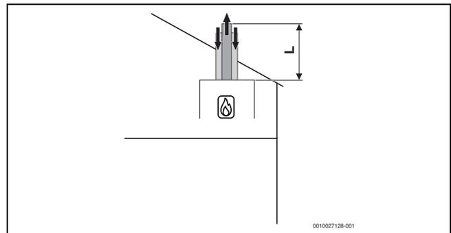
Bild 9 Vertikale konzentrische Luft-Abgas-Führung nach C<sub>33x</sub>
