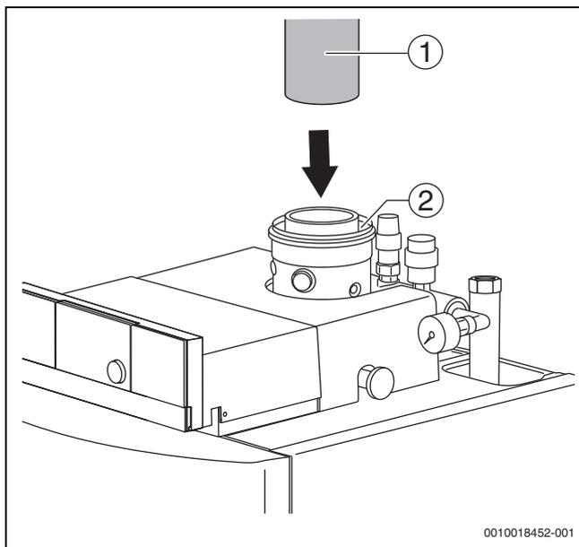
Bild 15 Montage Abgasrohr
