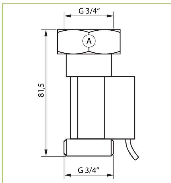
Abb. 1: Impulsgeber - Abmessungen in mm
