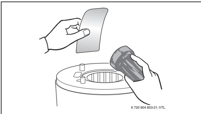
Bild 83 Wärmeblock auf Rückstände prüfen
