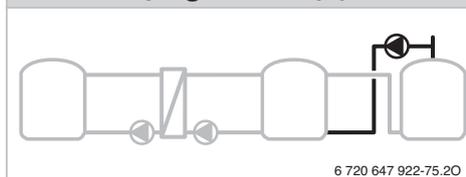
Thermische Desinfektion der Warmwasserspeicher und der Umladestation zur Vermeidung von Legionellen (→ Trinkwasserverordnung)
