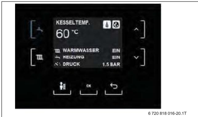
Bild 31 Basiscontroller Logamatic BC30 E
