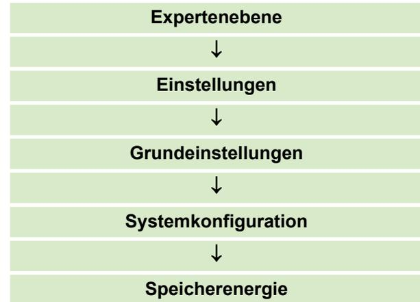
Zum Aktivieren eines Speichers wählen Sieden passenden Speichertyp aus. Sie können zwischen einem Kombipufferspeicher (z.B. REMKO MPS Speicher) oder einem Heizungspufferspeicher (z.B. REMKO HPS oder KPS Speicher) wählen.
