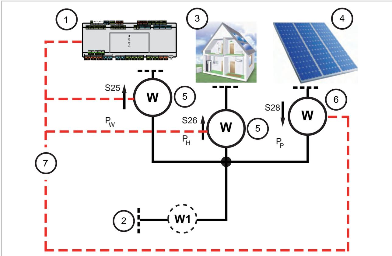
Abb. 2: Anordnung mit Zählern WP/Haushalt (EVU) mit Visualisierung am Smart-Control. Wärmepumpe über Wärmepumpentarif (Stufentarife)
