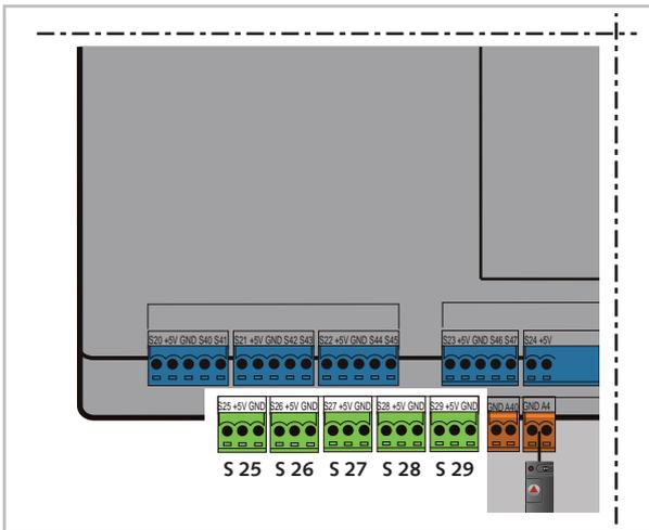
Abb. 5: Anschluss am I/O-Modul
