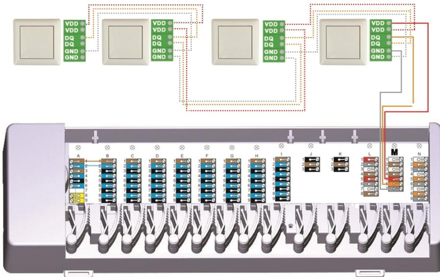
**Beispiel 2:** Baumstruktur. Von einer Hauptleitung führen mehrere Stichleitungen zu den einzelnen Sensoren.
