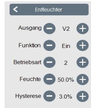
**Ausgang:** Schaltausgang der Funktion.
