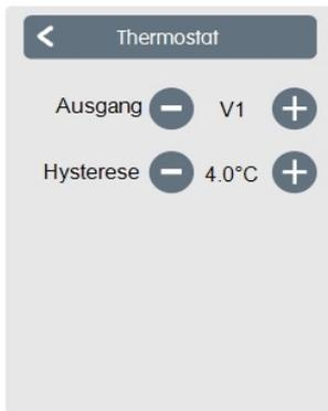
**Ausgang:** Schaltausgang der Funktion.
