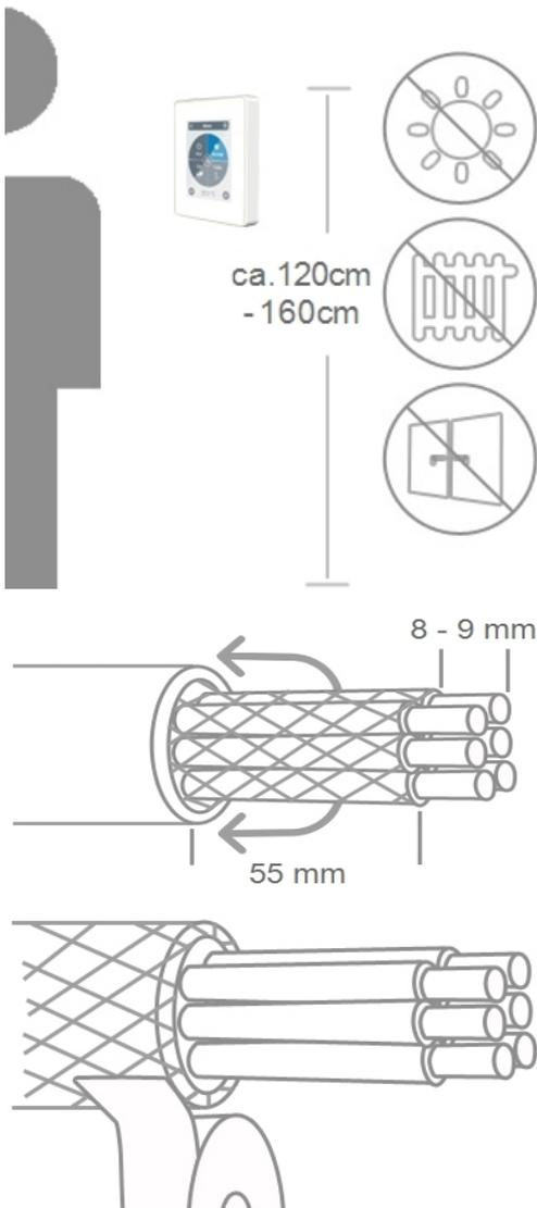
Kabel abmanteln, Schutzleiter überstülpen und Füllmaterial bei Bedarf entfernen.
