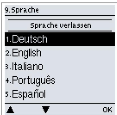
Über das Menü „9. - Sprache“ kann die Sprache der Menüführung gewählt werden. Bei der ersten Inbetriebnahme erfolgt die Abfrage automatisch. Die wählbaren Sprachen können sich je nach Geräteausführung unterscheiden! Die Sprachwahl ist nicht in jeder Geräteausführung vorhanden!
