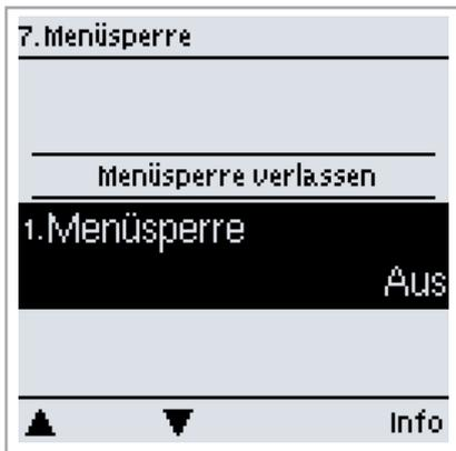
Durch das Menü „7. - Menüsperre“ kann der Regler dagegen gesichert werden, dass die eingestellten Werte unbeabsichtigt verstellt werden.
