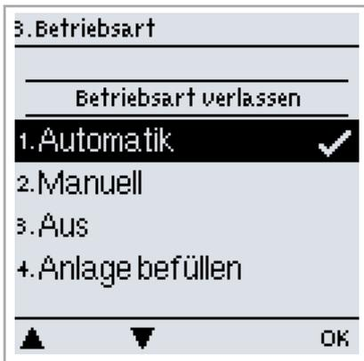
Im Menü "3. Betriebsarten" kann der Regler neben dem Automatikbetrieb auch ausgeschaltet oder in einen manuellen Betriebsmodus versetzt werden.
