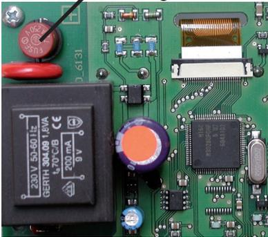
Hat der Regler trotz eingeschalteter Netzspannung keine Funktion und Anzeige mehr, so ist es möglich, dass die interne Gerätesicherung defekt ist. Dann das Gerät wie unter C beschrieben öffnen, alte Sicherung entfernen und überprüfen. Die defekte Sicherung wechseln, externe Fehlerquelle (wie z.B. Pumpe) finden und austauschen.
