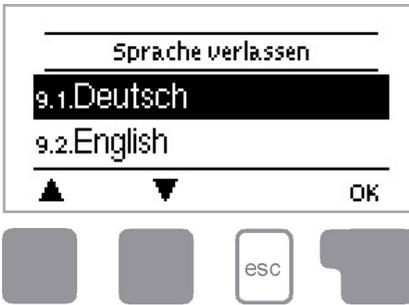
Über das Menü "9. Sprache" kann die Sprache der Menüführung gewählt werden. Bei der ersten Inbetriebnahme erfolgt die Abfrage automatisch. Die wählbaren Sprachen können sich je nach Geräteausführung unterscheiden! Die Sprachwahl ist nicht in jeder Geräteausführung vorhanden!
