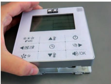
Abb. 3: Demontage der Gehäuseabdeckung
