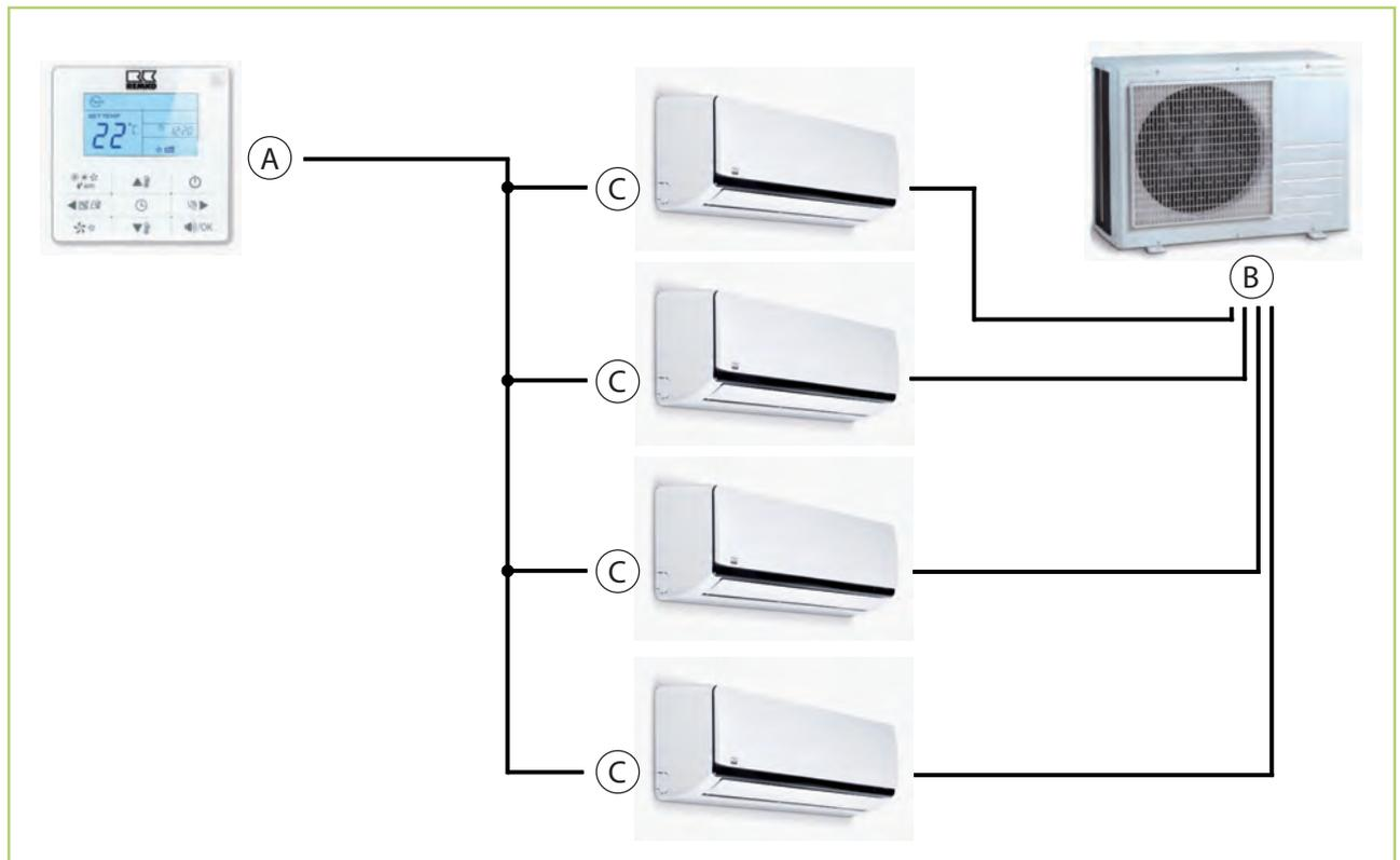
*Abb. 7: Montage Multisplitkombination mit einer Fernbedienung*
