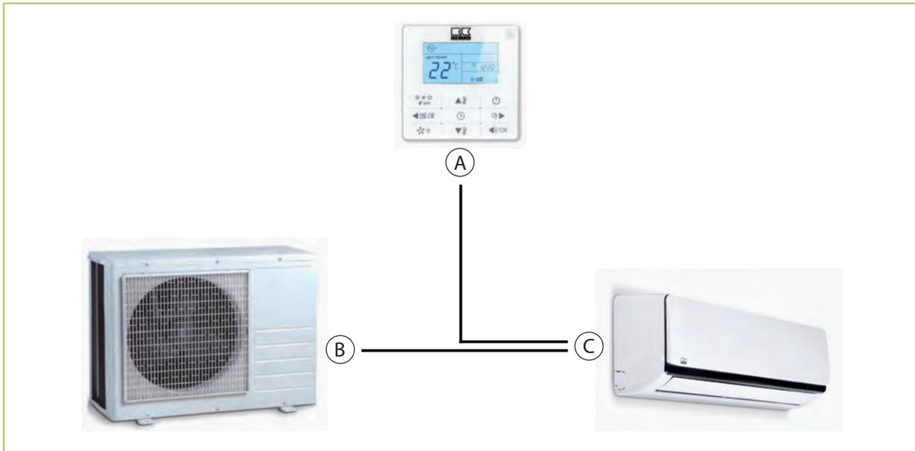
Abb. 5: Montage Singlesplitkombination mit einer Fernbedienung
