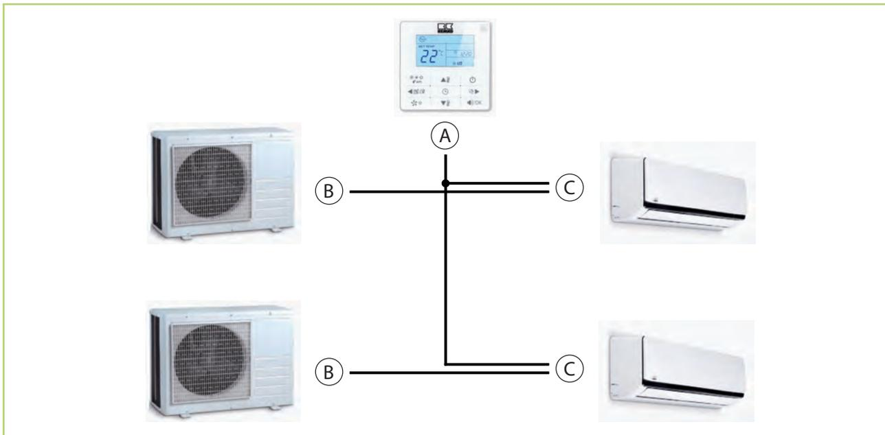
Abb. 6: Montage zweier Singlesplitkombinationen mit einer Fernbedienung
