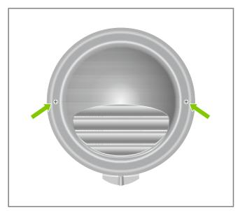
Die Regenschutzhaube mit Schrauben an der Fassade befestigen (Es muss gegebenenfalls zusätzliches Montagematerial bauseits gestellt werden).
