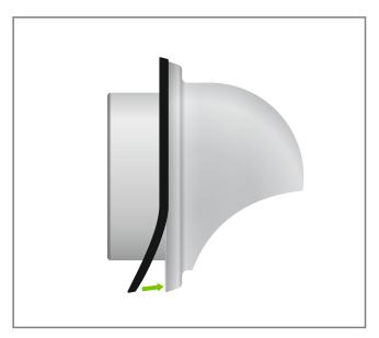
■ Die Nut der Dichtung an den Kragen der Regenschutzhaube drücken.
