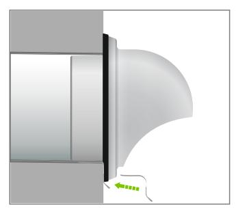
Das Kondensat-Ableitblech zwischen die Wand und den Luftkanal klemmen.
