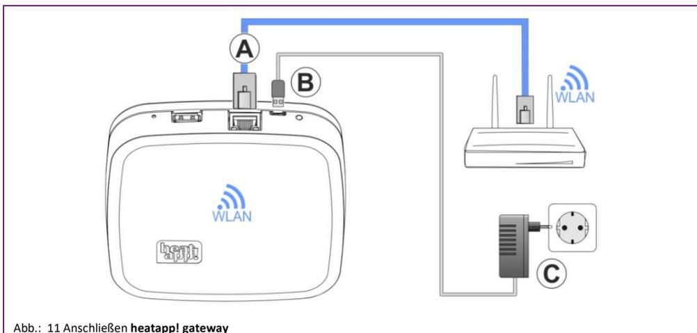
Abb.: 11 Anschließen **heatapp! gateway**
