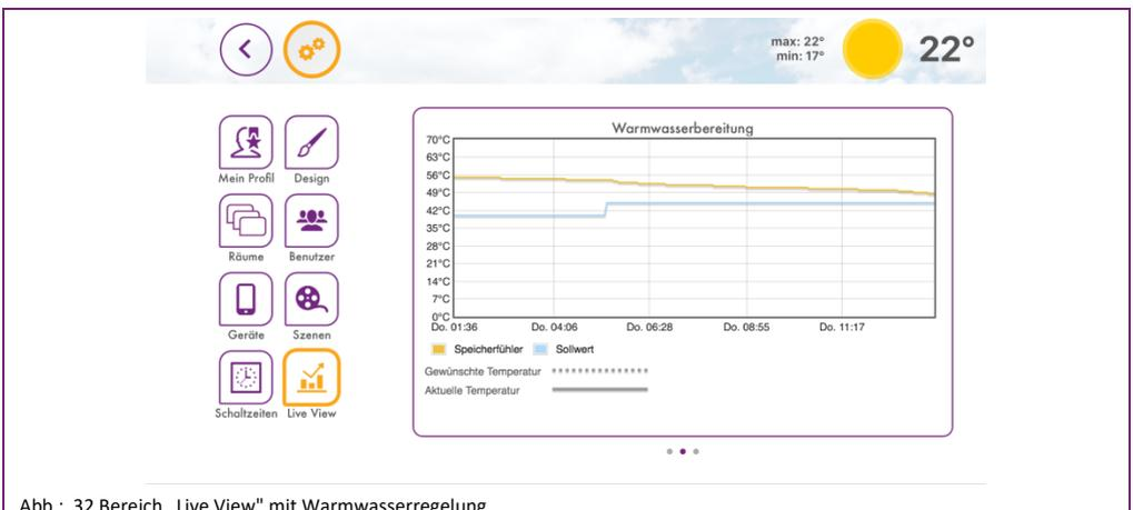
Abb.: 32 Bereich „Live View“ mit Warmwasserregelung
