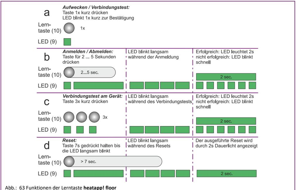
Abb.: 63 Funktionen der Lerntaste heatapp! floor
