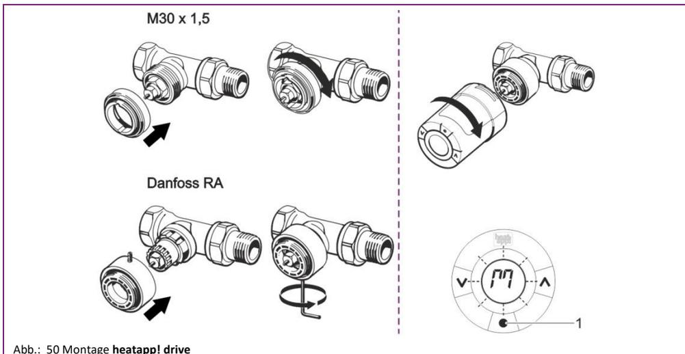
Abb.: 50 Montage **heatapp! drive**
