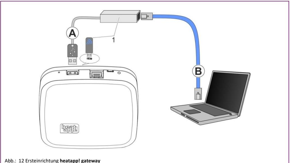
Abb.: 12 Ersteinrichtung **heatapp! gateway**
