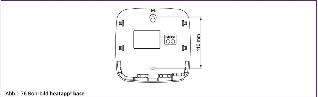
Abb.: 76 Bohrbild heatapp! base
