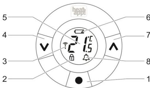
Abb.: 47 Bedienung heatapp! drive
