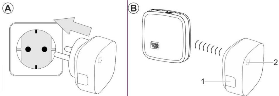
Abb.: 66 Installation **heatapp! repeater**
