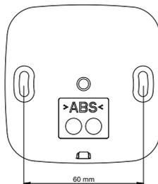
Abb.: 77 Bohrbild **heatapp! sense**
