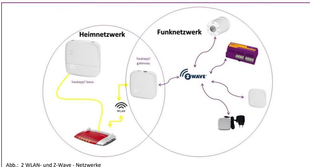
Abb.: 2 WLAN- und Z-Wave - Netzwerke
