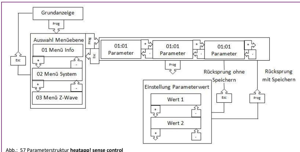
Abb.: 57 Parameterstruktur heatapp! sense control
