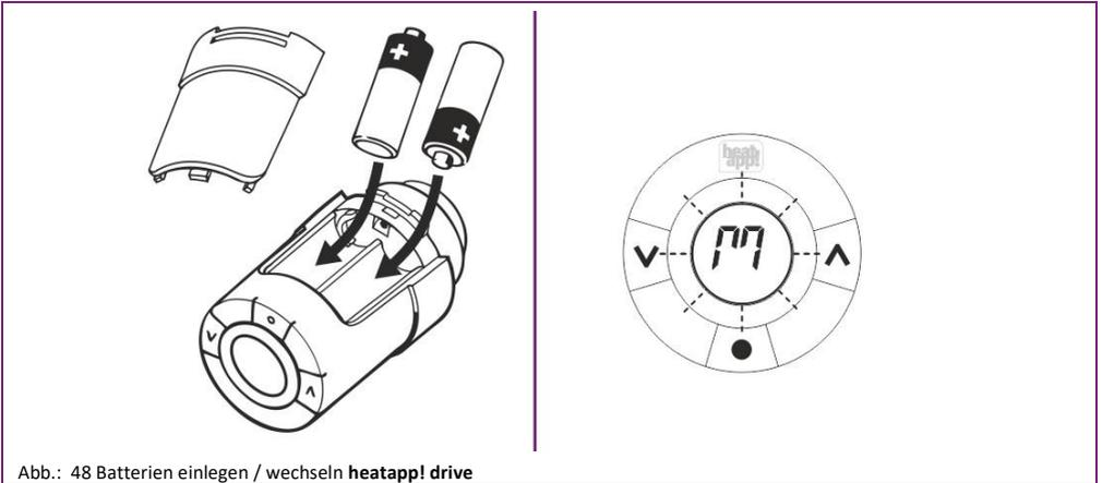
Abb.: 48 Batterien einlegen / wechseln **heatapp! drive**
