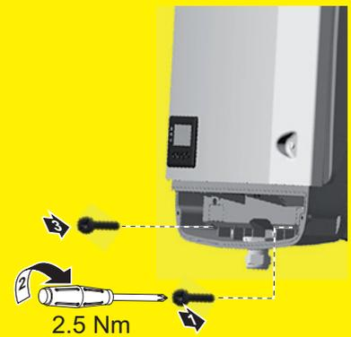
Den Wechselrichter immer mittels Fixierungsschrauben mit dem in der Bedienungsanleitung angegebenen Drehmoment fest an der Montagehalterung verschrauben. Wechselrichter ausschließlich mit festgezogenen Fixierungsschrauben in Betrieb nehmen!
