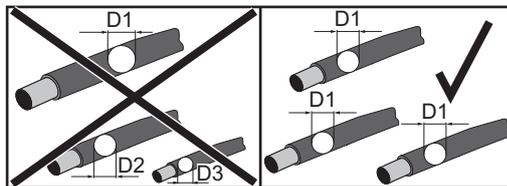
**HINWEIS!** Um eine effektive Zulentlastung der Solarmodulstränge zu gewährleisten, ausschließlich gleich große Kabelquerschnitte verwenden.
