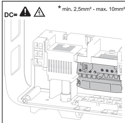
max. Kabelquerschnitt pro DC Kabel: 10 mm<sup>2</sup>
