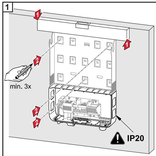
*Tip: Wechselrichter so montieren, dass das Display auf Augenhöhe ist*
