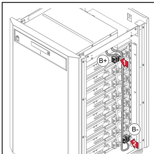
**1** Spannung zwischen  $U_{B-}$  und  $U_{B+}$  überprüfen
