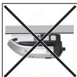
Den Wechselrichter nicht an der Decke montieren.
