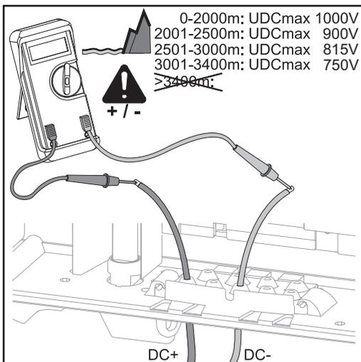
**! VORSICHT!** Gefahr möglicher Schäden am Wechselrichter! Polarität und Spannung der Solarmodul-Stränge vor dem Anschließen überprüfen: die Spannung darf folgende Werte nicht überschreiten:
