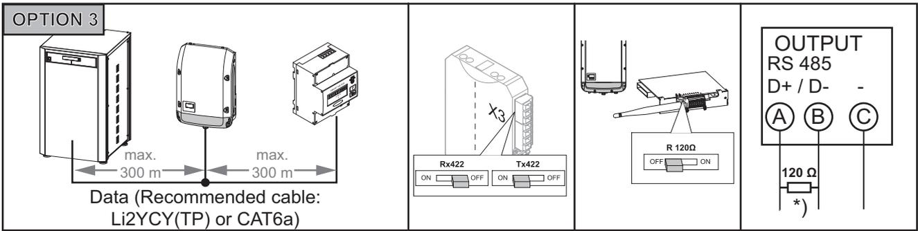
\*) Abschlusswiderstand R 120 Ohm liegt beim Fronius Smart Meter bei
