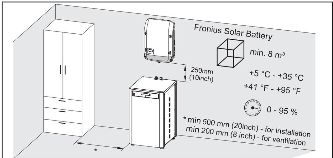
\* für das Einbauen der Batteriemodule in den Batterieschrank wird ein seitlicher Abstand von 500 mm benötigt
