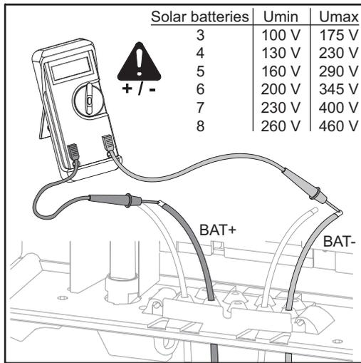
**WICHTIG!** Überprüfen Sie die Spannung der Batteriemodule!
