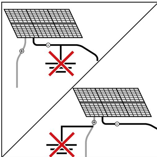
Der Hybrid-Wechselrichter ist ein trafloses Gerät. Die einzelnen Pole der Solarmodule dürfen nicht geerdet werden.
