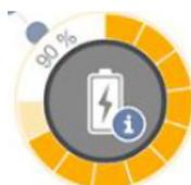
In Fronius Solar.web oder am Webinterface des Wechselrichters wird in der Übersicht die Kalibrierladung als Information angezeigt. Durch Klicken auf das Batteriesymbol (Bild links) ist die Information „Die Batterie befindet sich im Kalibriermodus“ ersichtlich
