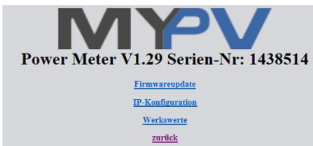
Über das Web-Interface kann auch die Firmware des Power Meter aktualisiert werden. Diese ist im „Software Package Power Meter.zip“ auf [www.my-pv.com](http://www.my-pv.com) enthalten.
