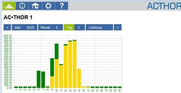
Gelbe Balken zeigen den Energieanteil der aus der Photovoltaik stammt, grüne Balken den Anteil der optionalen Temperatursicherstellung.
