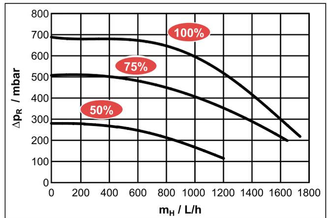
Bild 10-5 Restförderhöhe der internen Heizungsumwälzpumpe mit Heizungsunterstützungswärmeübertrager
