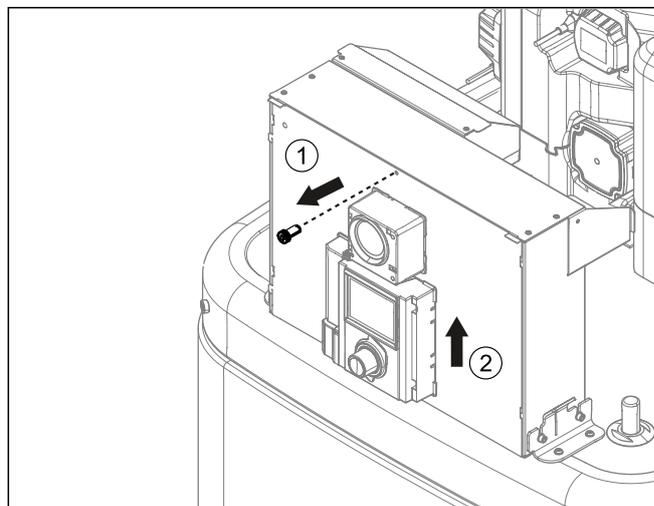
Bild 4-12 Regelungsgehäuse öffnen
