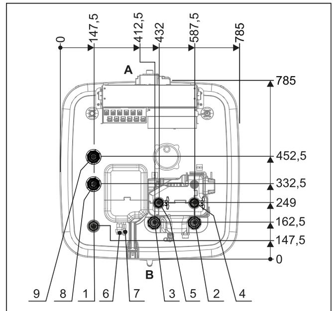
Bild 4-4 Abmessungen Geräteoberseite - Typ ...04P50D/...08P50D
