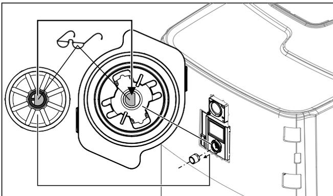
Bild 4-22 Drehtaster aufsetzen
