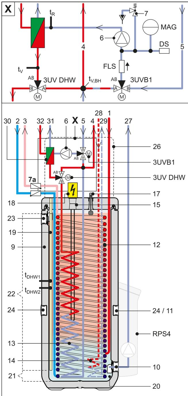
Bild 3-3 Aufbau und Bestandteile – Innenaufbau ...04P30D/...08P30D (Biv)<sup>(1)</sup>
