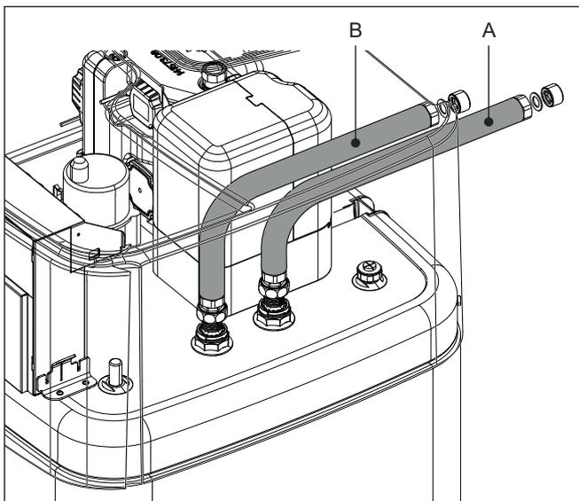
Bild 4-26 P-Anschlusskit für Biv-Gerätetypen
