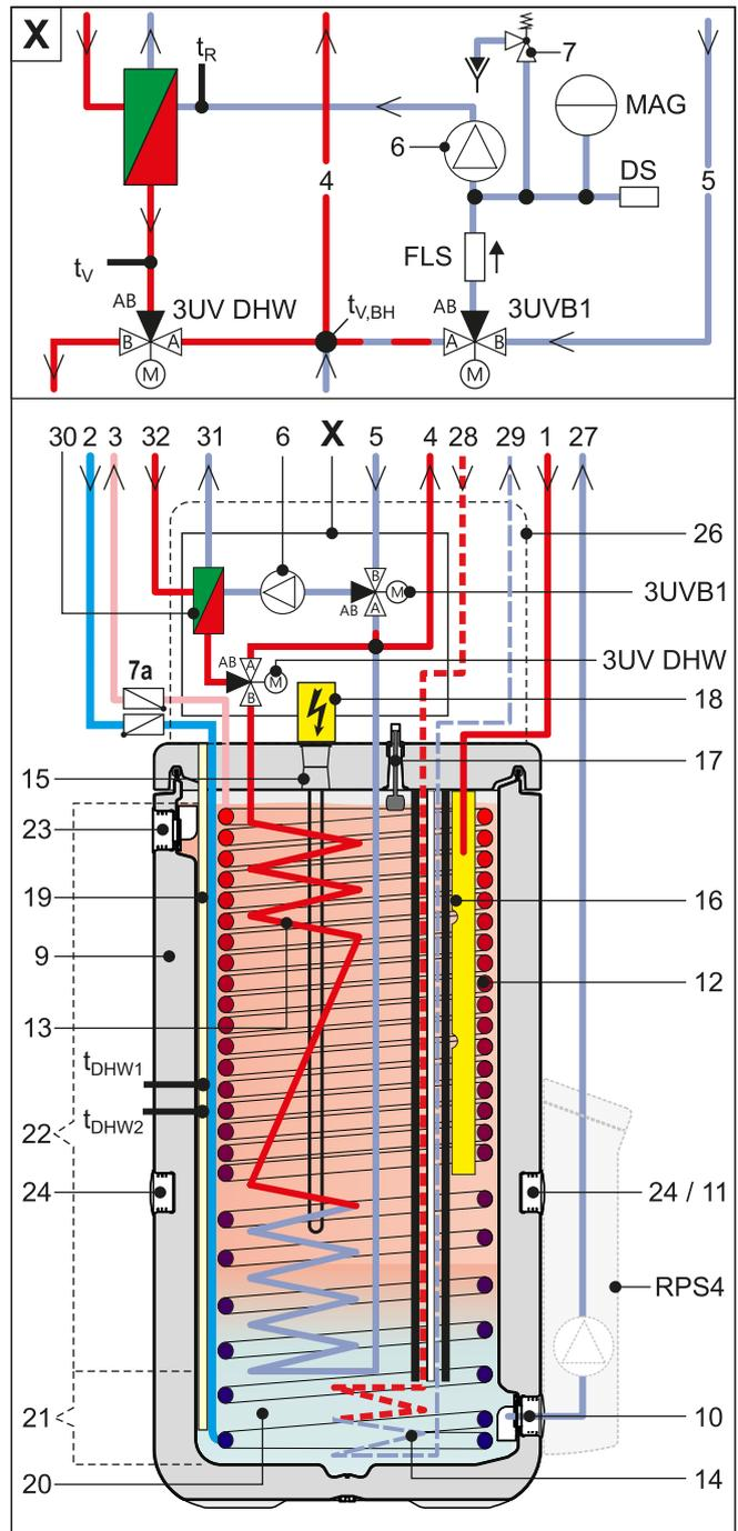
Bild 3-4 Aufbau und Bestandteile - Innenaufbau ...04P50D / ...08P50D (Biv)<sup>(1)</sup>
