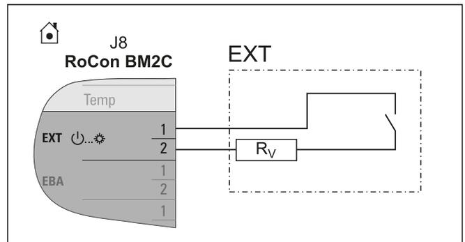
Bild 4-36 Anschluss EXT-Schaltkontakt
