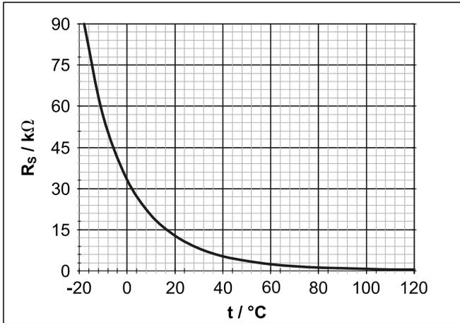
Bild 10-2 Kennlinie der Temperaturfühler  $t_{DHW1}, t_{V, BH}$
