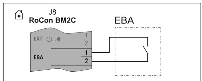
Bild 4-37 Anschluss EBA-Schaltkontakt
