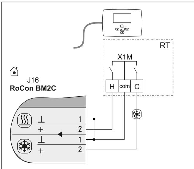
Bild 4-39 Anschluss mit kabelgebundenem Raumthermostat (RT = Daikin EKRTW)
