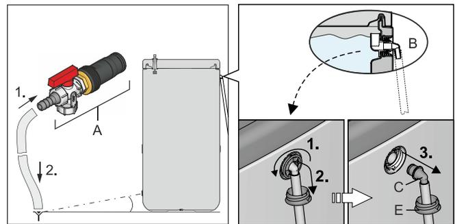
Bild 9-1 Ablaufschlauch montieren; Optional: Anschlussstück vom Sicherheitsüberlauf demontieren
