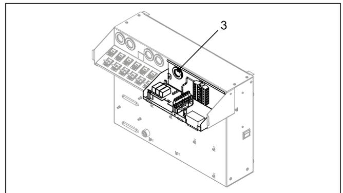
Bild 4-24 Kabeldurchführung
