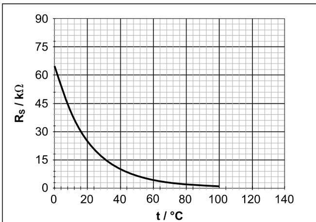
Bild 10-3 Kennlinie der Temperaturfühler  $t_R, t_V, t_{DHW2}, t_{DC}$
