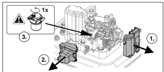
Bild 4-16 Entlüftungsventil öffnen
