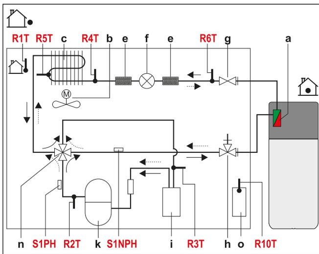
Bild 8-1 Bauteile im Wärmepumpenkreislauf
