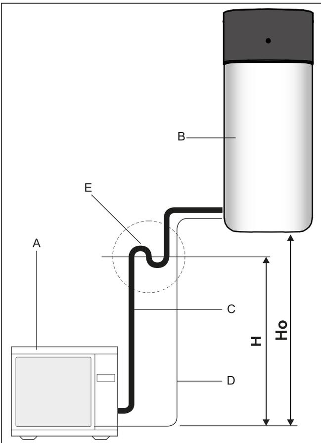
Bild 4-46 Ölfangbogen Kältemittelleitung
