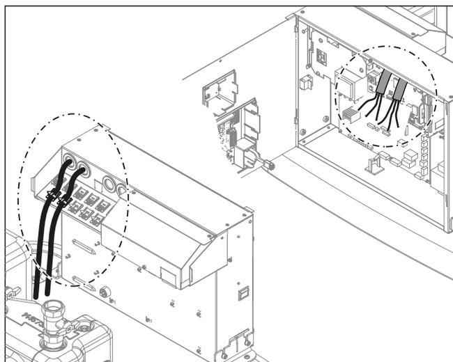
Bild 4-33 Kabeldurchführung
