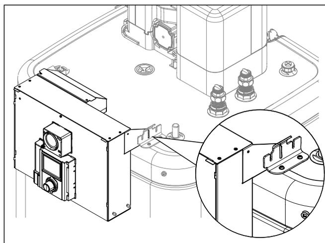
Bild 4-11 Regelungsgehäuse in Serviceposition
