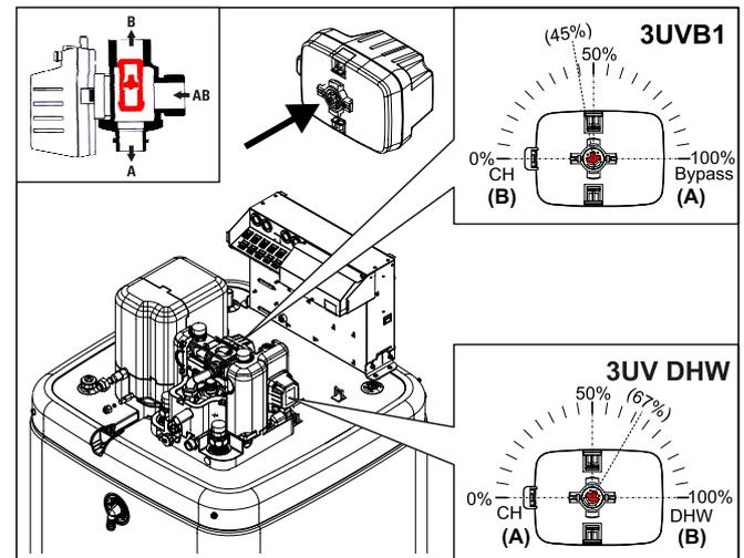
Bild 3-5 Funktion 3-Wege-Umschaltventil
