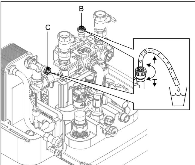
Bild 5-2 Manuelle Entlüftungsventile
