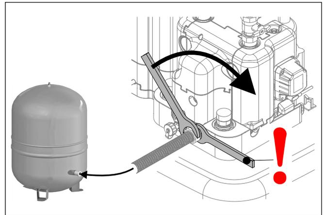
Bild 4-29 Membranausdehnungsgefäß anschließen
