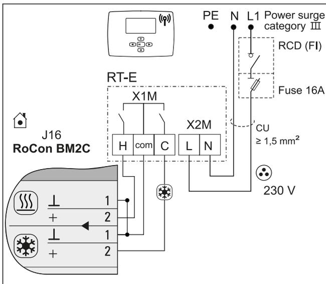
Bild 4-40 Anschluss mit Funk-Raumthermostat (RT-E = Daikin EKRTTR)
