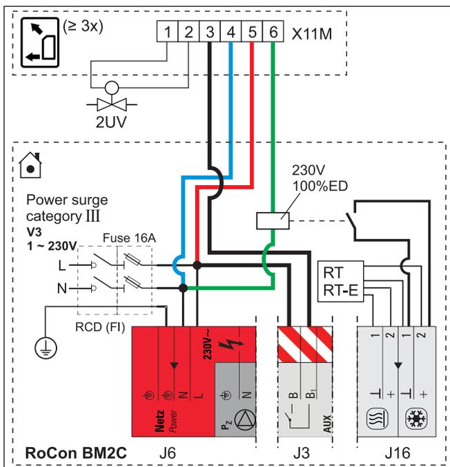
Bild 4-42 Anschluss HP convector (min. 3) an das Innengerät
