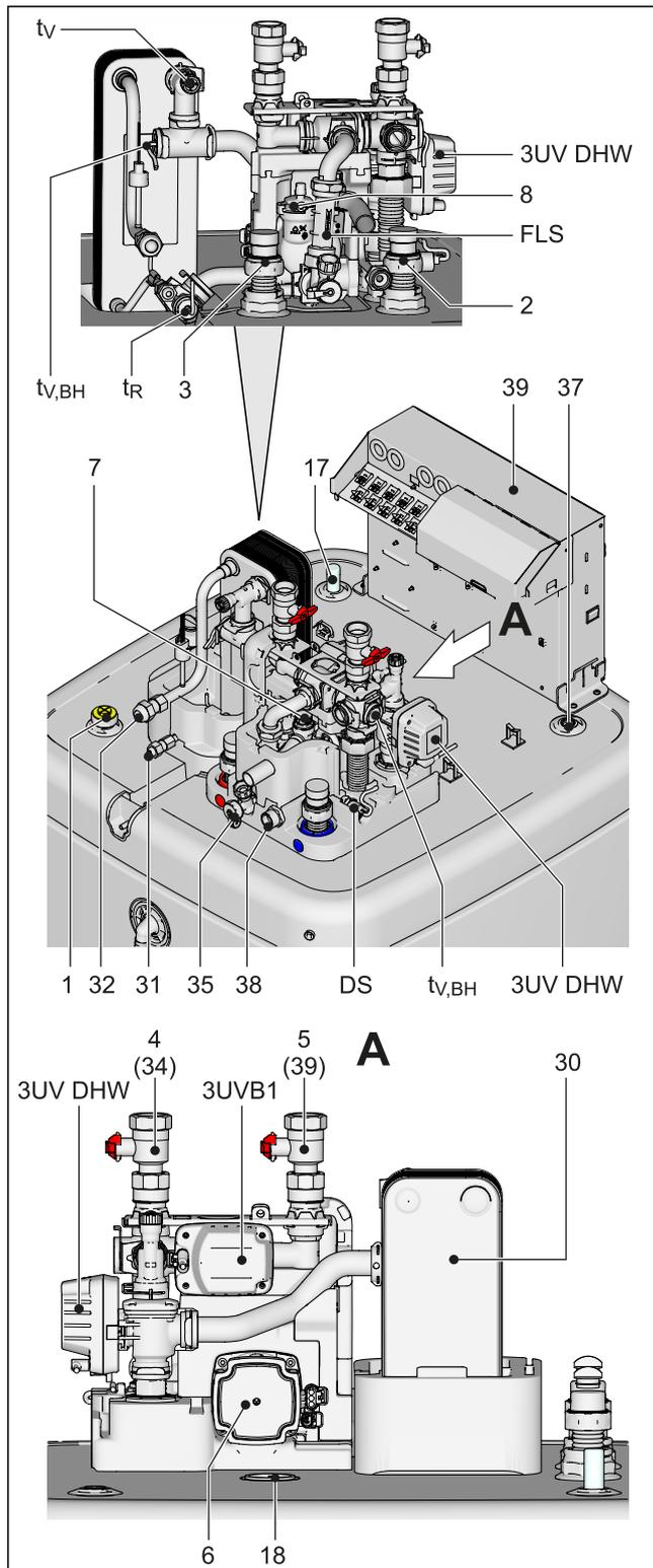
Bild 3-2 Aufbau und Bestandteile - Geräteoberseite<sup>(1)</sup>
