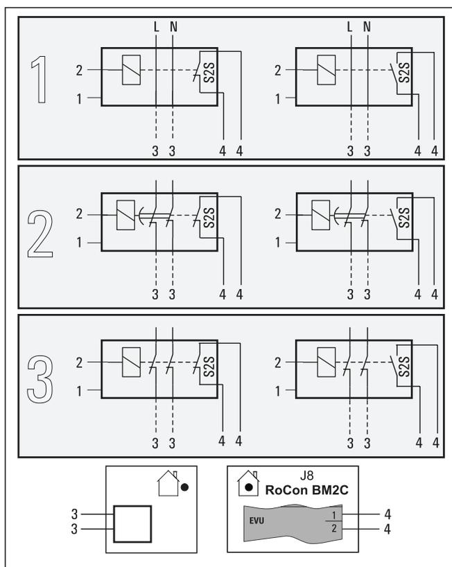
Bild 4-44 Anschluss H/NT-Schaltkontakt
