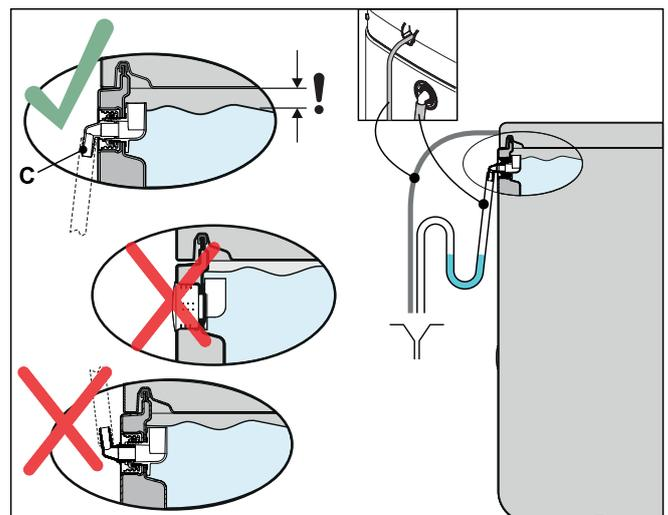
Bild 4-30 Anschluss des Überlaufschlauchs
