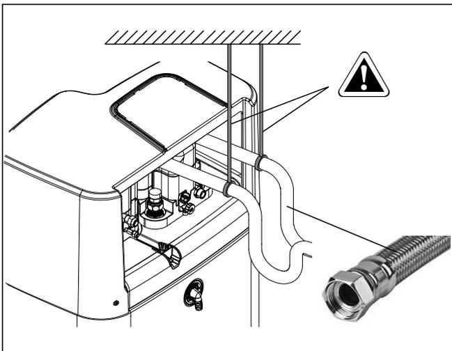
Bild 4-28 Anschluss nach hinten: Hydraulische Leitungen abstützen
