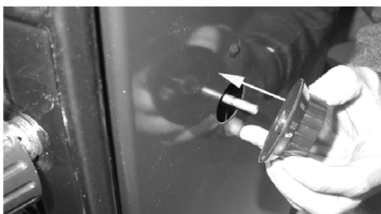
**Abbildung 3:** Montage des Leistungsreglerknopf
