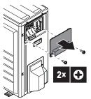
3 Entfernen Sie die Abdeckung der Wartungsplatine.
