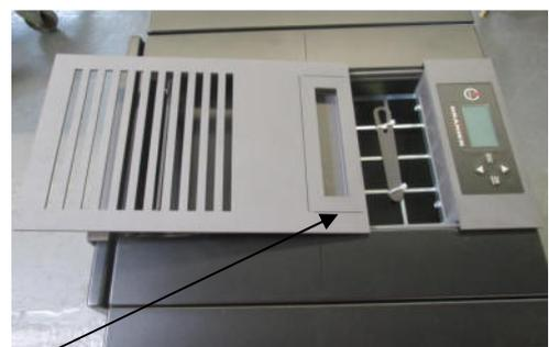
Einfüllöffnung für Pellets mit Eingriffsschutz
