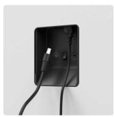
Die Kabelbuchse für den Anschluss ist auf der Rückseite des Geräts positioniert, dadurch wird das vorhandene Volumen im oberen Gehäuseteil sinnvoll genutzt. Gleichzeitig sind die Anschlüsse aus dem Sichtbereich entfernt. Hier befindet sich auch der ON/OFF Schalter für die Software. Dieser muss lediglich bei Inbetriebnahme betätigt werden.
