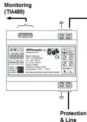
Das AConversion RF-Gateway wird benötigt, um die empfangenen Daten in Standard-RS-485 zu konvertieren. Weitere Informationen über das AConversion RF-Gateway entnehmen aus dem separaten Gateway-Handbuch.
