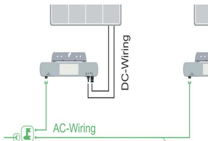
Der AC-Anschluss liegt an der linken Seite des Anschlussbereichs und erfolgt über eine Leitung mit einem 3-poligen 16A-Stecker. Über einen Verteilerblock können jeweils zwei Wechselrichter mit dem gesamten Stromkreis verbunden werden.
