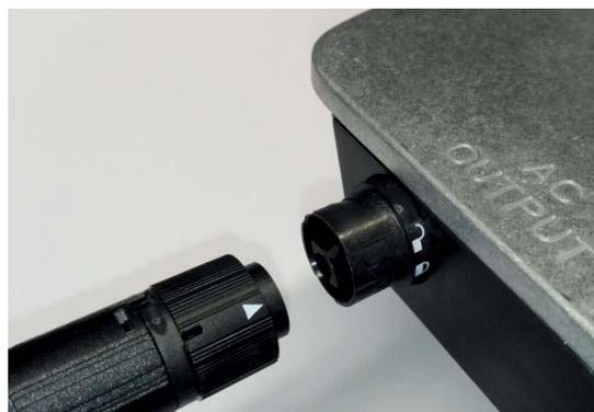
Überprüfen Sie die korrekte Verriegelung des Steckverbinders, in dem der weiße Pfeil auf das geschlossene Verriegelungssymbol zeigt.
