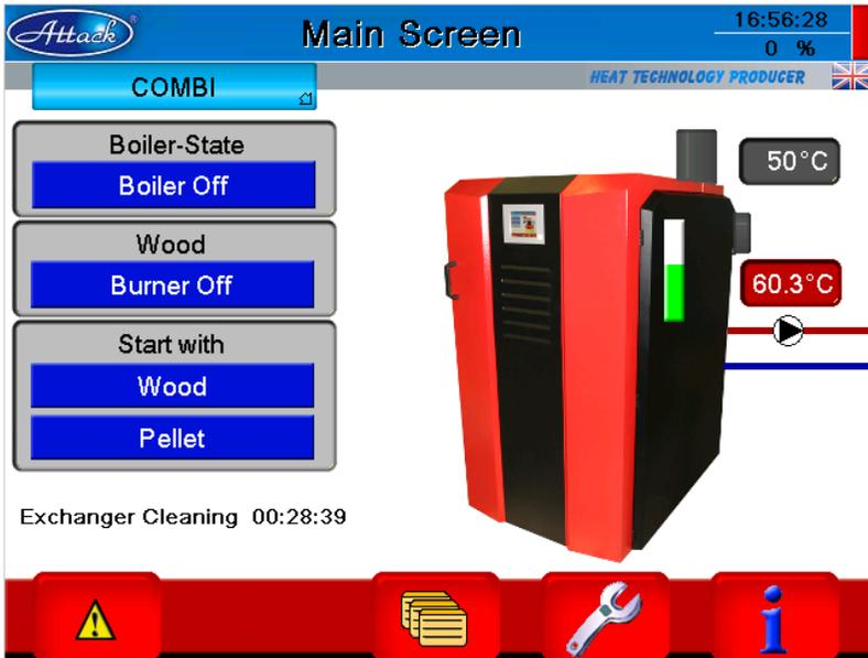
**Bild 21 Menü KOMBİ: Wahl des Brennstoffes, mit welchem der KOMBİ-MODUS gestartet werden soll.**
