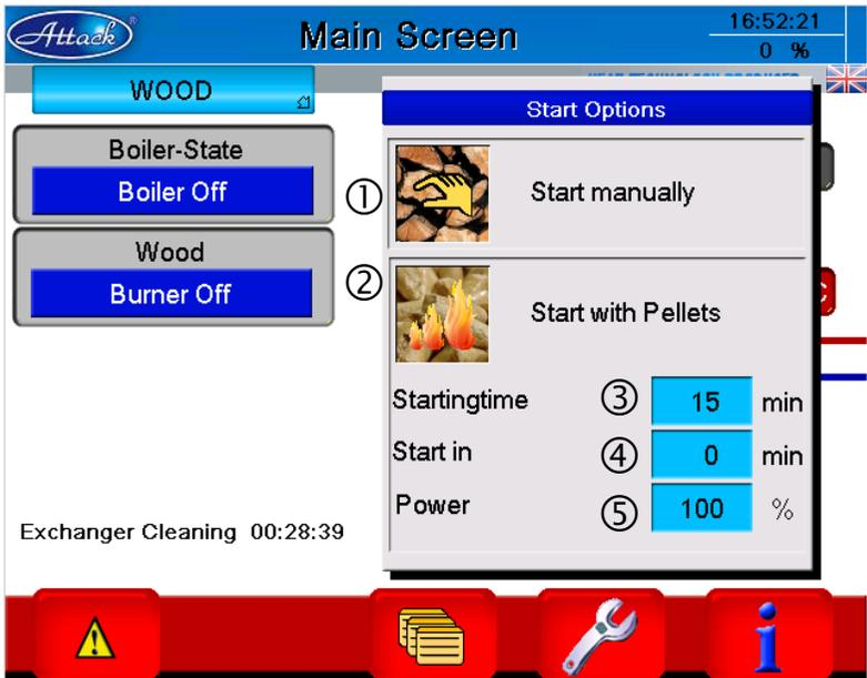
**Bild 19 Parameter der automatischen Zündung**
