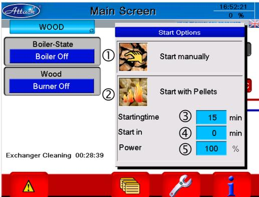
**Bild 16 Anzündverfahren von Holz im Holzvergaserenteil:**
