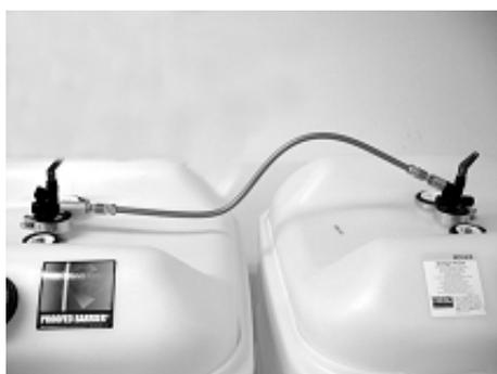
Den letzten Tank mit Verschlusskappe und eingelegter Dichtung verschließen.
