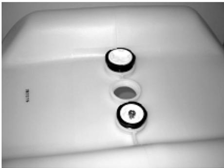
Die Sicherheitsarmatur (Art.Nr. 110118.02) aus Sicherheitsarmatur Grundpaket (Art.Nr. 110118) entnehmen und einschrauben.
