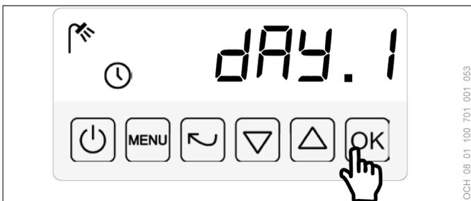
» Benutzen Sie die Auf-Taste und Ab-Taste, um zwischen on und off zu wechseln.
