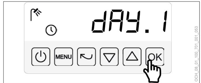
» Benutzen Sie die Auf-Taste und Ab-Taste, um zwischen on und off zu wechseln.
