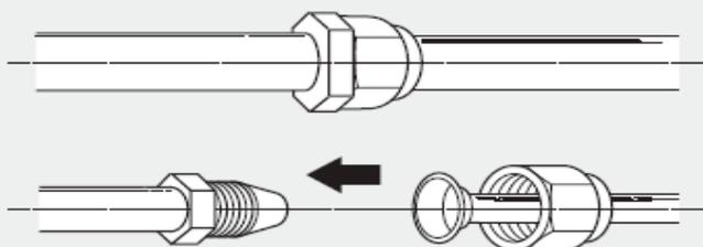
Die Kältemittelleitungen vom Innengerät zum Außengerät verlegen, dabei ausreichend befestigen und ggf. Maßnahmen zur Ölrückführung treffen
