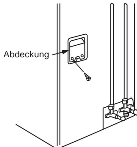
Der Schaltplan der Außeneinheit befindet sich innen auf der Kabelabdeckung der Außeneinheit.
