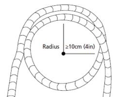
**Hinweis: Beim Biegen der Kältemittelleitungen sollte der Biegeradius min. > 10 cm (Durchmesser > 20 cm) betragen. Das Rohr keinesfalls an der selben Stelle zweimal wegen Versprödung und Rißgefahr biegen**
