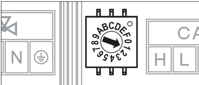
Bild 4-2 Einstellung Geräteerkennung für Mischermodule RoCon M1
