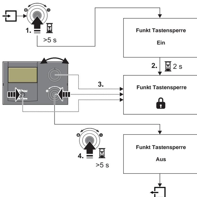
Bild 3-4 Tastensperre aktivieren (1.) und deaktivieren (4.)
