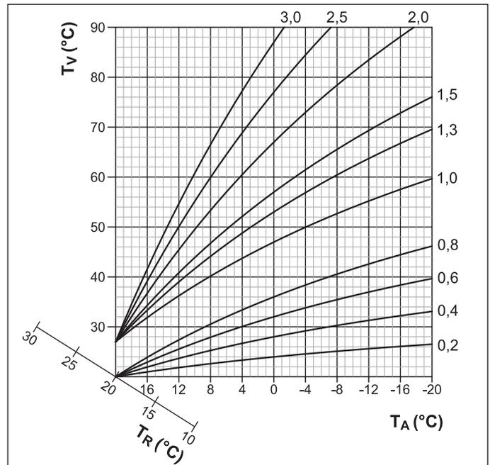
$T_A$  Außentemperatur  $T_V$  Vorlauftemperatur
