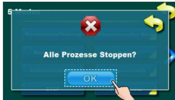
**WICHTIG!** Um alle Prozesse zu beenden, muss der Kessel erst mit ON/OFF Taste
