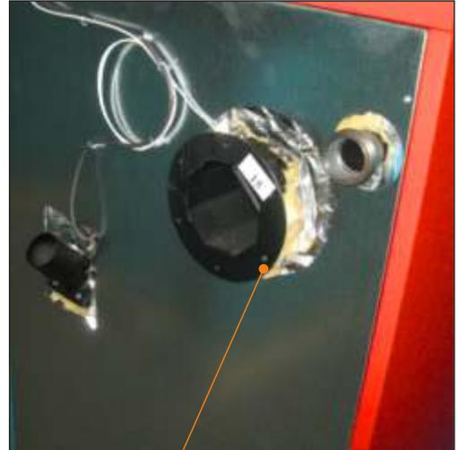
Flansch für die Montage des Ventilators
