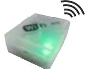
**GSM Modul zur Alarmmeldung durch das Mobilnetz**
