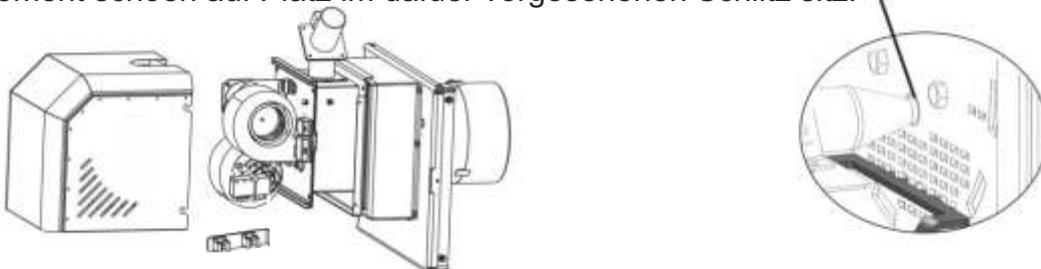
5. Die Schutzhaube mit 4 Schrauben befestigen.
