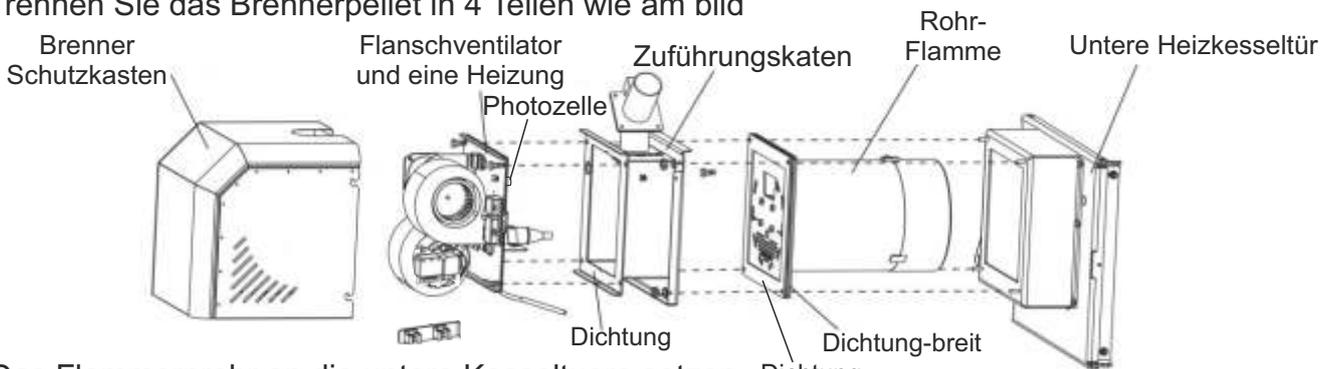
2. Das Flammernrohr an die untere Kesseltuere setzen
