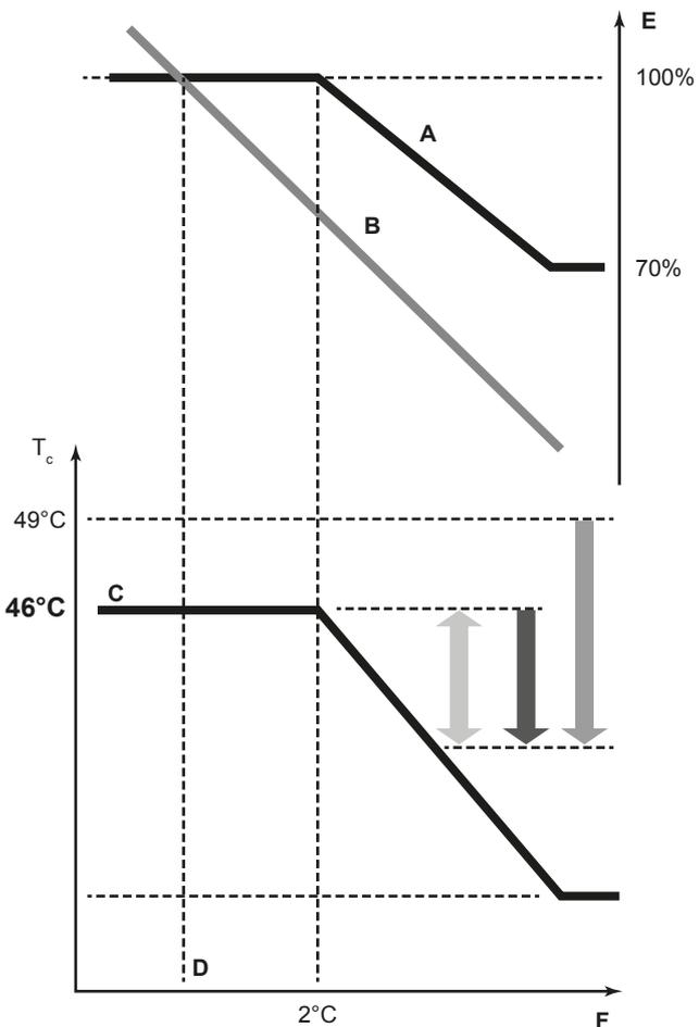
A Virtuelle Belastungskurve (Standard-Spitzenauslastung im automatischen Modus)
