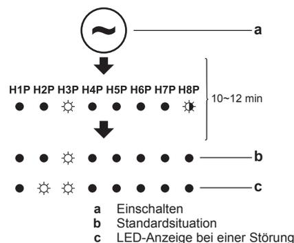
Wenn nach 10~12 Minuten die Standardsituation nicht angezeigt wird, überprüfen Sie den Fehlercode auf der Benutzerschnittstelle der Inneneinheit. Je nach Fehlercode sind dann die entsprechenden Maßnahmen zu ergreifen. Überprüfen Sie zunächst die der Kommunikation dienenden Verkabelung.
