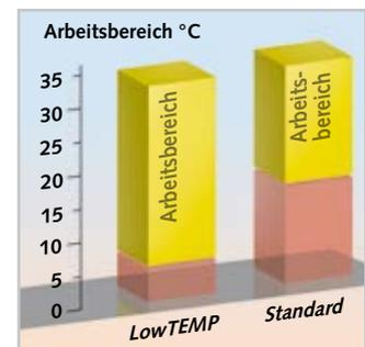
Entfeuchtungseinsatz bei LowTEMP-Ausführung schon ab 6 °C möglich
