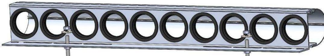
Fußteil mit Scheibe und Mutter befestigen, ausrichten und die Muttern fest anziehen.
