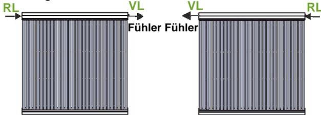
Anschlussmöglichkeiten für mehrere horizontale Kollektoren in Serie (max. 90 Röhren):
