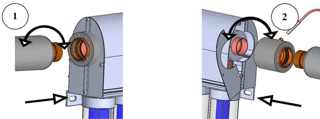
**Fühlermontage:** Fühler in die Fühlertauchhülse einführen mit Schrumpfschlauch verbinden. Den Schrumpfschlauch mit einer Wärmequelle schrumpfen oder mit beigelegter Schutzfolie umkleben.
