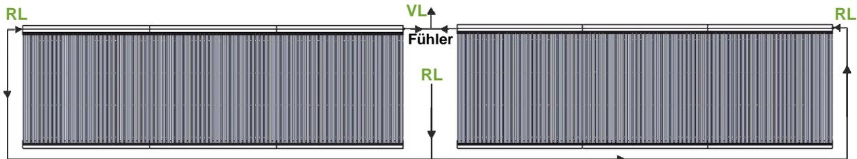
Anschlussmöglichkeiten für mehrere vertikale Kollektoren in Serie und parallel (max. 90 Röhren):
