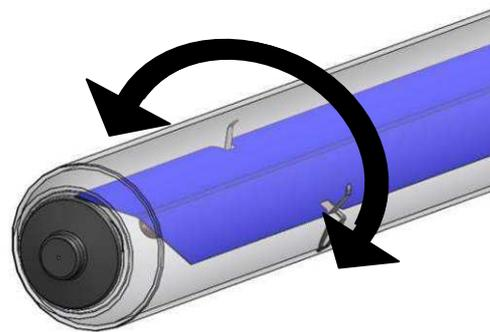
Bei einer Anlage für Brauchwasser Erwärmung empfehlen wir Ihnen den Kollektor 45° und bei der Kombination Brauchwassererwärmung und Heizungsunterstützung den Kollektor 60° aufzuständern. Zusätzlich können die Röhren nach Süden ausgerichtet werden.
