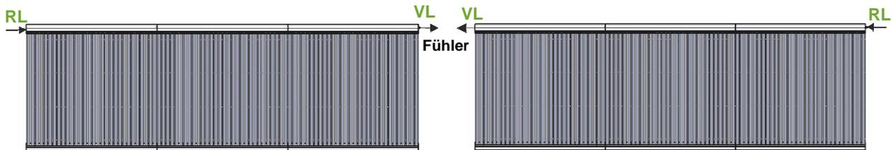
Anschlussmöglichkeiten für mehrere horizontale Kollektoren in Serie und parallel (max. 90 Röhren):
