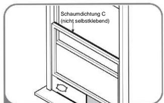
3 Schneiden Sie die Schaumdichtung C auf die richtige Fensterbreite ab. Setzen Sie die Dichtung zwischen Glas und Fensterrahmen ein damit keine Außenluft oder Insekten in den Raum gelangen können.
