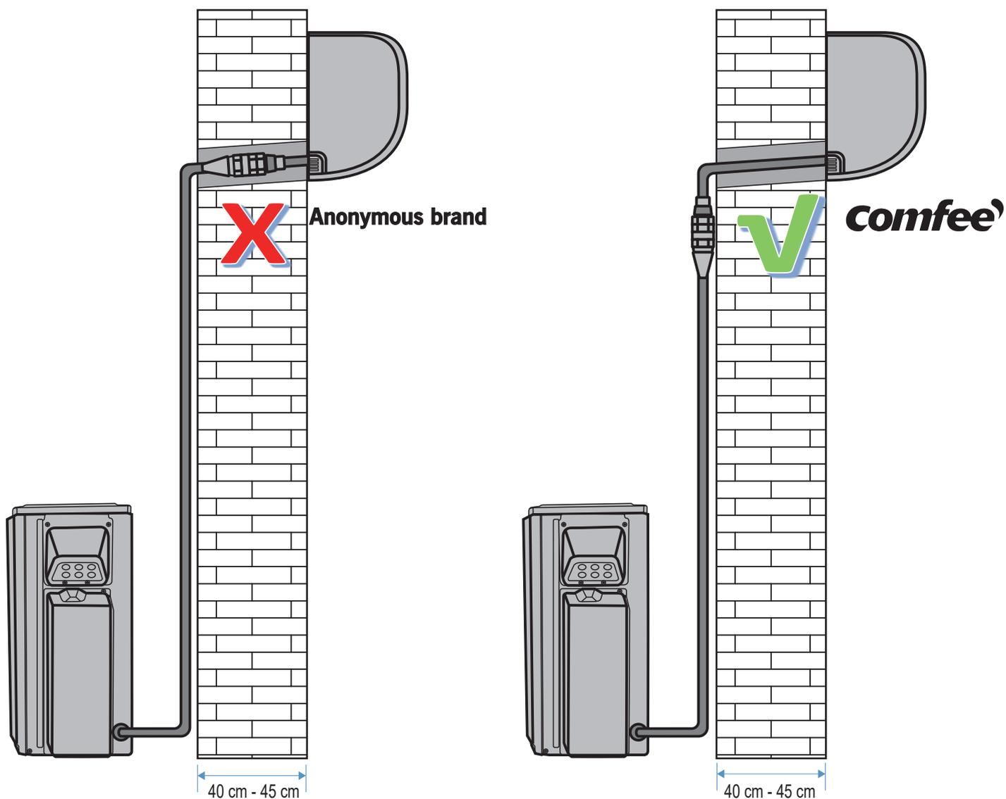
Gemäß EN 60335-2-40, für brennbare Kältemittel, sollten Rohrleitungsanschlüsse außerhalb von Gebäuden liegen.
