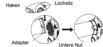
Vergewissern Sie sich, dass der Adapter in die untere Nut des Luftauslasses eingesetzt ist.
