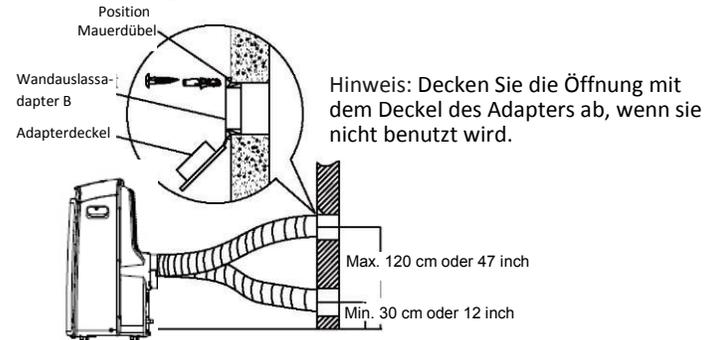
Hinweis: Überdehnen oder verbiegen Sie den Schlauch nicht zu stark. Achten Sie darauf, dass sich kein Hindernis um den Luftauslass des Abluftschlauchs (im Bereich von 500 mm) befindet, damit das Abluftsystem ordnungsgemäß funktioniert. Alle Abbildungen in dieser Anleitung dienen lediglich zur Illustration. Ihr Klimagerät kann davon leicht abweichen. Die tatsächliche Form ist maßgebend.
