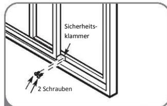
4 Wenn gewünscht, montieren Sie die Sicherheitsklammer wie gezeigt mit den beiden Schrauben.
