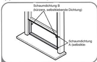
1 Schneiden Sie die Schaumdichtungen A und B auf die richtige Länge zu und kleben Sie sie wie gezeigt auf den Fensterflügel und den Fensterrahmen.
