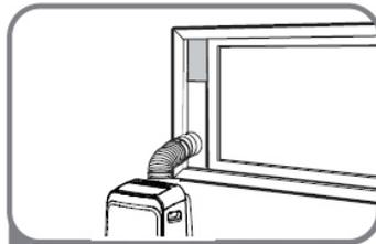
5 Setzen Sie den Schiebefensteradapter in die Öffnung des Fensterschiebers ein.
