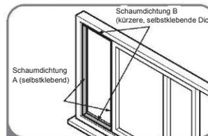
1 Schneiden Sie die Schaumdichtungen A und B auf die richtige Länge zu und kleben Sie sie wie gezeigt auf den Fensterflügel und den Fensterrahmen.
