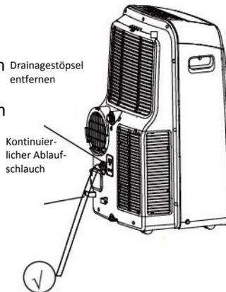
Entfernen Sie bei den beim Wärmepumpenmodus den Kondensatablauf-Stöpsel unten an der Rückseite des Geräts, und schließen Sie über den Kondensatablaufadapter (5/8" Anschluss) einen 3/4" Schlauch an (lokal zu besorgen). Bei Modellen ohne Anschlussstück schließen Sie den Ablaufschlauch direkt an die Öffnung an. Positionieren Sie das andere Ende des Schlauchs direkt über einem Abfluss Ihres Fußbodens.
