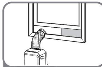
5 Setzen Sie den Schiebefensteradapter in die Öffnung des Fensterschiebers ein.
