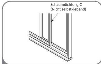
3 Schneiden Sie die Schaumdichtung C auf die richtige Fensterhöhe ab. Setzen Sie die Dichtung zwischen Glas und Fensterrahmen ein damit keine Außenluft oder Insekten in den Raum gelangen können.
