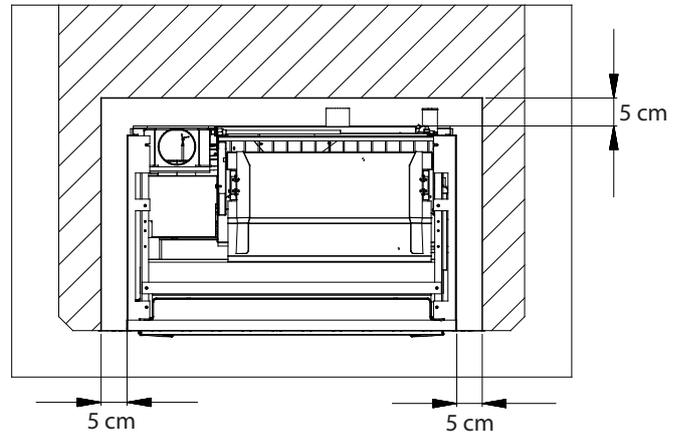
Für einen einwandfreien Betrieb des Kamineinsatzes sind beim Bau des Kamins die Maße zwischen Kamineinsatz und Innenwänden des Kamins zu beachten (Abbildungen unten).
