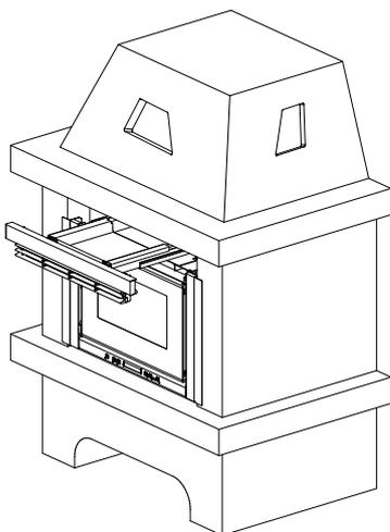
Der optionale Bausatz zur Pelletzufuhr ermöglicht das frontale Einfüllen der Pellets in den Behälter, ohne den Kamineinsatz herauszuziehen (hierbei muss das Gerät ausgeschaltet werden).
