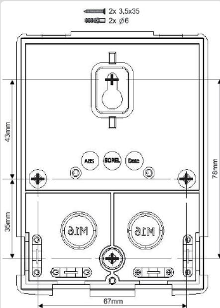
5. Mittels Bohrmaschine und 6er Bohrer mindestens 2 Löcher an den angezeichneten Stellen in die Wand bohren und die Dübel eindrücken. Optional kann der Regler auch mit 4 Befestigungslöchern befestigt werden.
