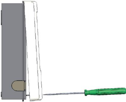
1. Deckelschraube komplett lösen
