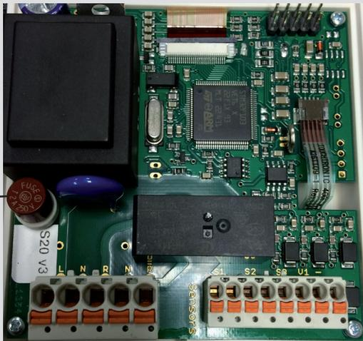
Hat der Regler trotz eingeschalteter Netzspannung keine Funktion und Anzeige mehr, so ist es möglich, dass die interne Gerätesicherung defekt ist. Dann das Gerät wie unter C.1 beschrieben öffnen, alte Sicherung entfernen und überprüfen.
