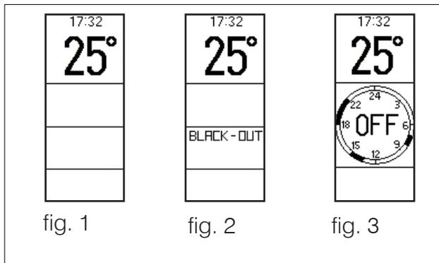
Von der Bildschirmseite OFF kann zur Bildschirmseite ON gewechselt werden, indem die physische Taste 3 Sekunden lang gedrückt wird.
