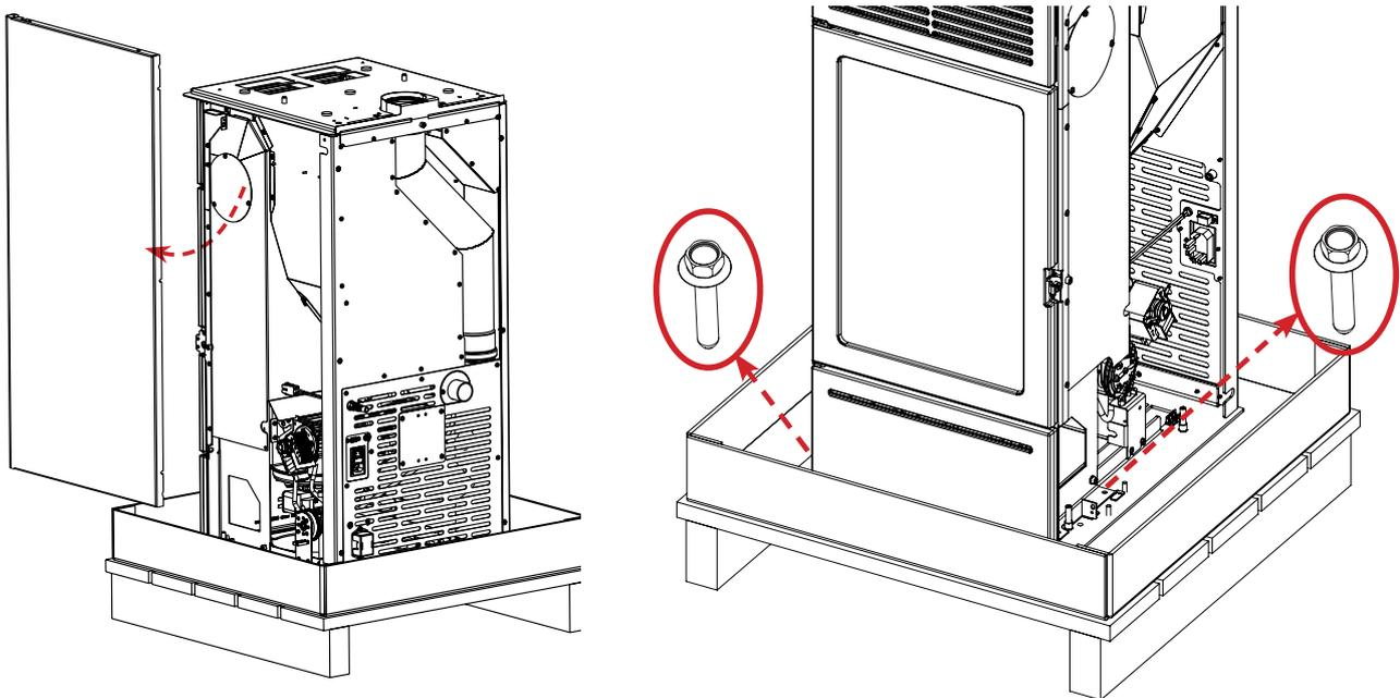
Die Seitenteile einrasten und die Schrauben an der Rückseite einschrauben.
