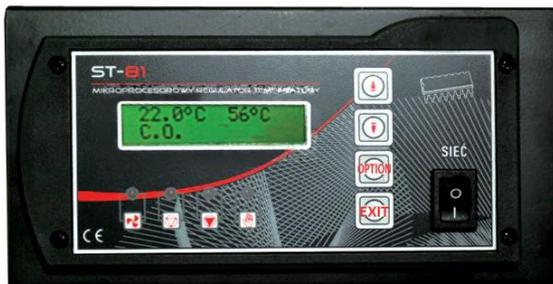
Der Regler zeigt die Rauchgastemperatur an und kontrolliert die Aufrechterhaltung der konstanten Kesseltemperatur, und eine zusätzliche Einstellung ist nicht notwendig. Durch die Verwendung dieses Reglertyps können Sie bis zu 13% Brennstoff sparen und die Ausgangswassertemperatur ist sehr stabil, was Einfluss auf eine längere Lebensdauer des Kessels hat. Die Kontrolle der Abgastemperatur garantiert eine niedrige Staub- und Gasemission, welche für die
