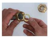
Den Dichtring in die Überwurfmutter einlegen und den Doppelnippel eindrehen. Durch festes Anziehen des Doppelnippels wird die vorstehende Welle zu einem planen Dichtsitz gestaucht. Doppelnippel und Dichtring wieder herausnehmen, eventuell noch vorhandenen Grat entfernen. Zur einfacheren Herstellung des Dichtsitzes ist als Zubehör ein Flanschschlagwerkzeug erhältlich.
