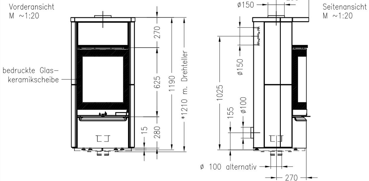
Bei Version mit Stahlverkleidung, seitliche Verkleidung einteilig!
