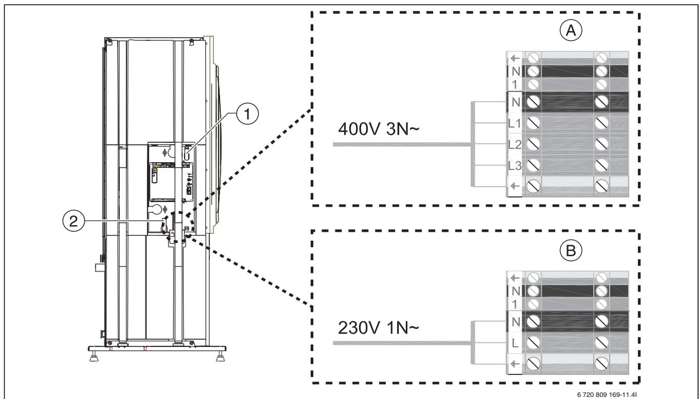
Bild 19 Kabelkanäle am Anschlusskasten der Wärmepumpe
