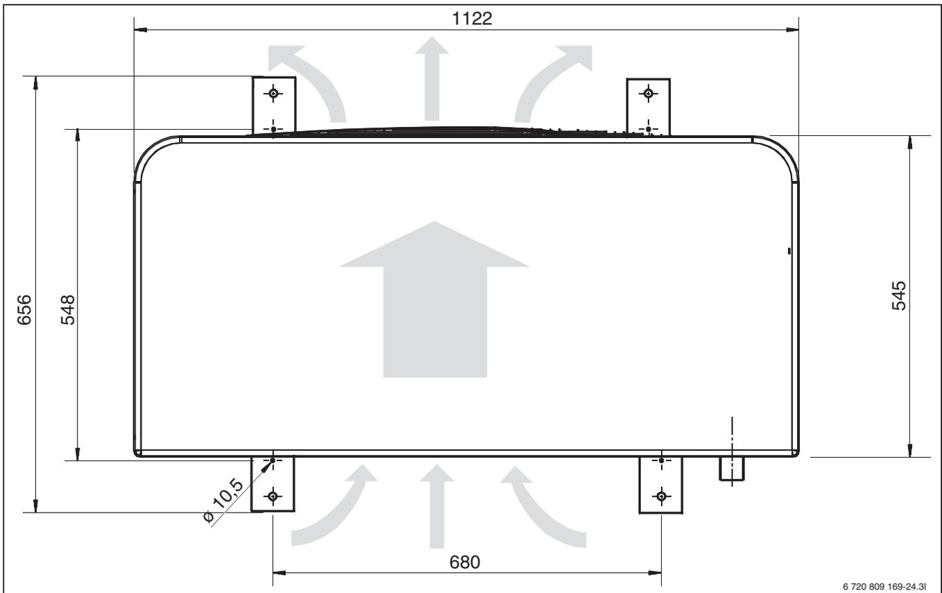
Bild 8 Abmessungen der Wärmepumpenmodelle 13–17, Ansicht von oben
