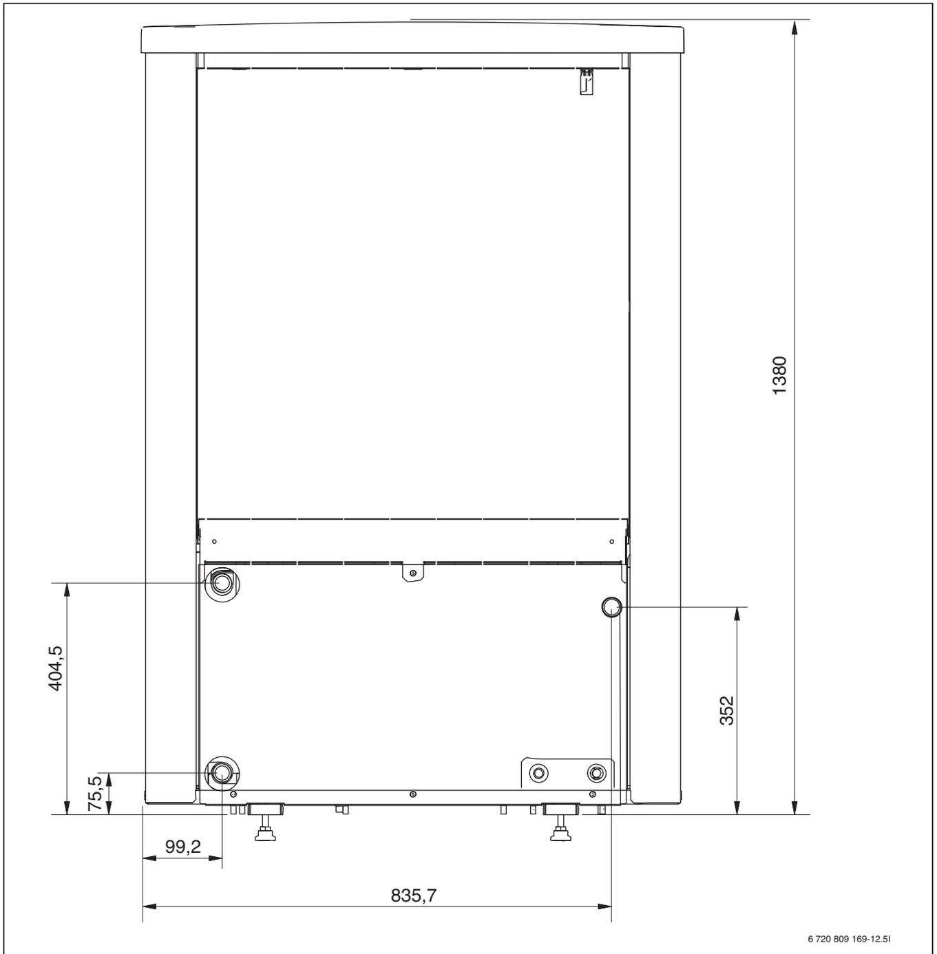
Bild 5 Abmessungen und Anschlüsse der Wärmepumpenmodelle 5–9, Rückseite
