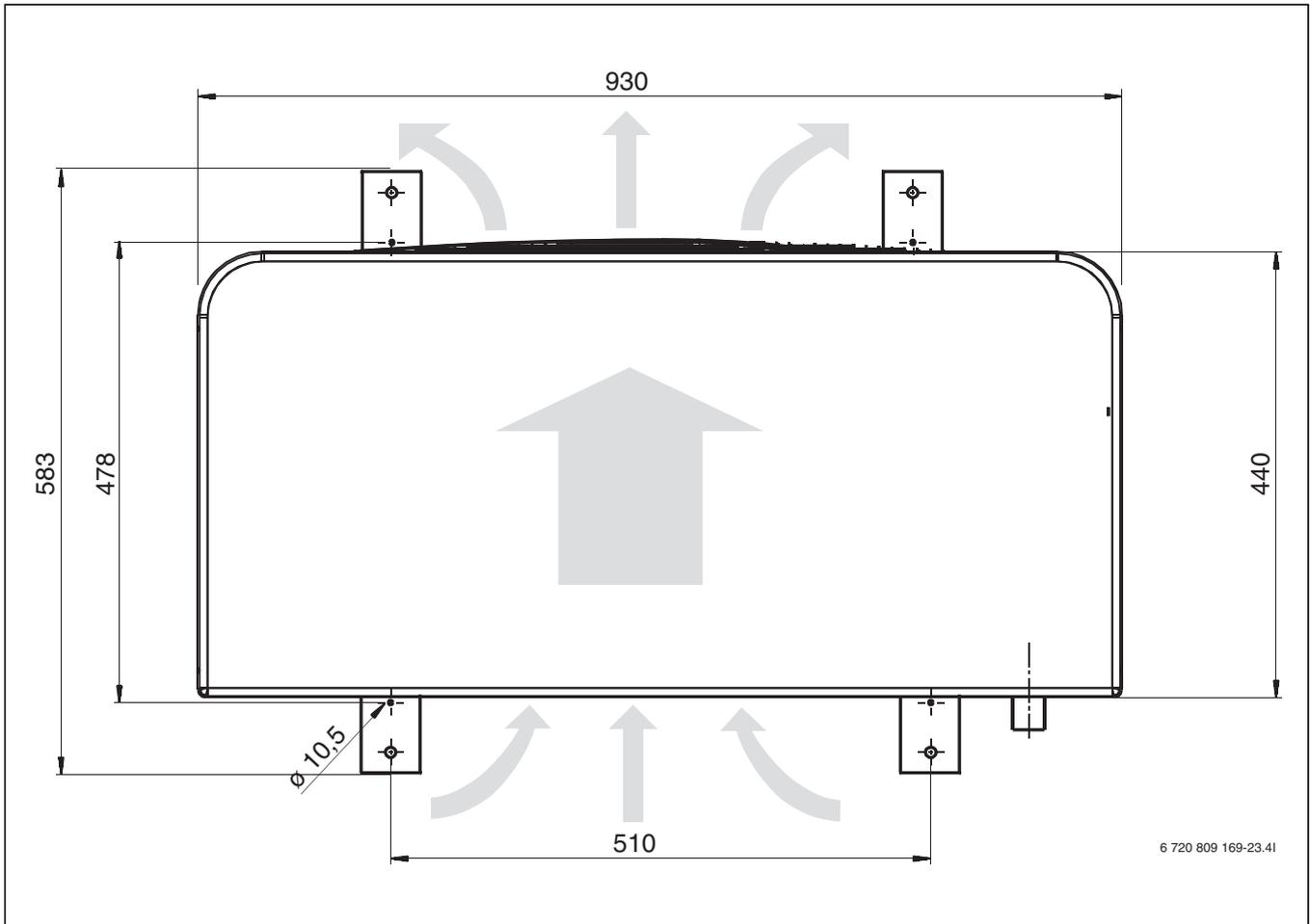
Bild 6 Abmessungen der Wärmepumpenmodelle 5–9, Ansicht von oben
