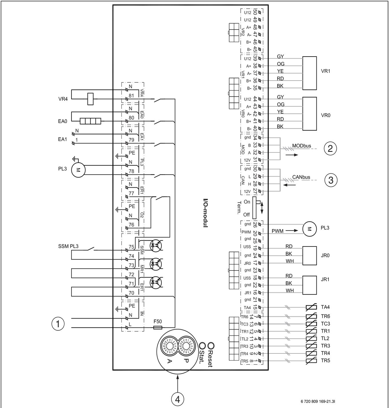
Bild 21 Schaltplan für I/O-Modulkarte
