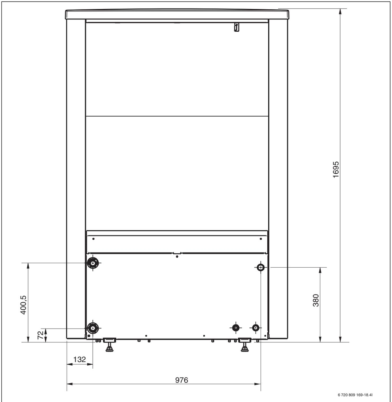
Bild 7 Abmessungen und Anschlüsse der Wärmepumpenmodelle 13–17, Rückseite
