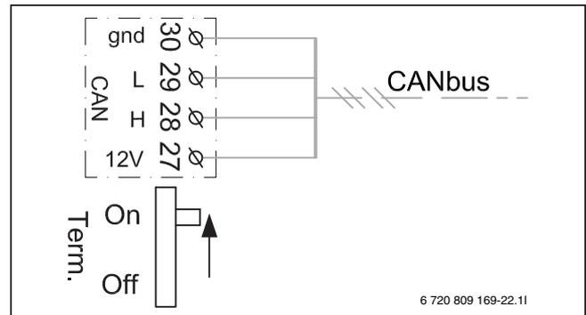
Bild 16 CAN-BUS-Terminierung
