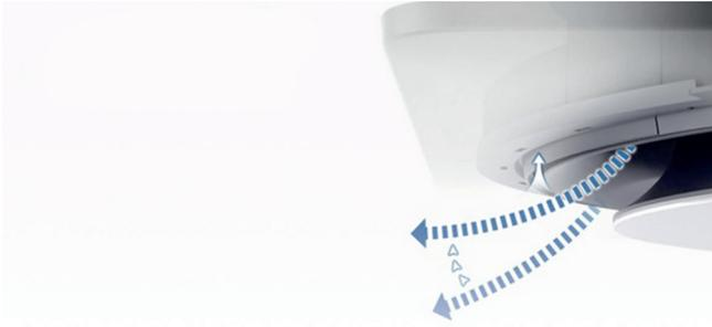
Die patentierte Luftaustrittswinkel Einstellung, von horizontal bis vertikal ohne Luftleitklappen, wird durch einen Boosterlüfter je 120° Zone bestimmt. Der Boosterlüfter saugt 0-5% (0 % für vertikal | 5 % für horizontal) der ausgeblasenen Luft um den Zonenauslass herum an, so dass die konditionierte Luft bei horizontaler Einstellung parallel zur Decke kommt und sich über einen Gesamtradius von 12 Meter gleichmäßig verteilt.
