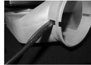
Das Anschlusskabel des Stellmotors sollte wie folgt aus dem Gerät bzw. aus dem SVS geführt werden, siehe Abbildung.
