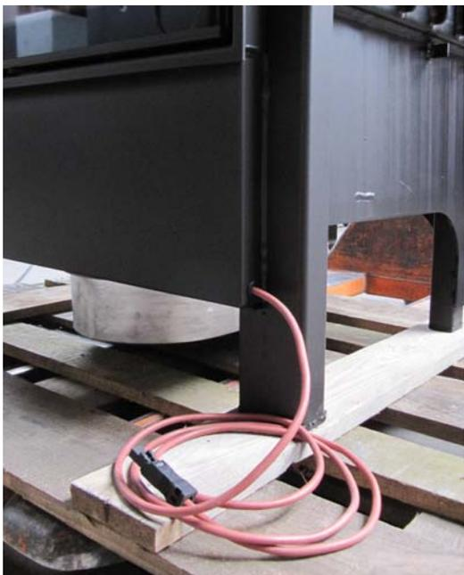
Innerhalb der Kaminverkleidung ist eine Leitungsreserve von mind. 20cm vorzuhalten, so dass bei Revisionsarbeiten der Türkontaktschalter durch die Brennzelle entnommen werden kann.
