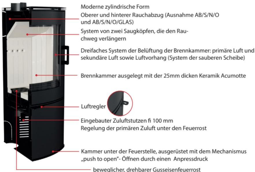
Das Modell des Ofens AB/S/NO ist mit einem Mechanismus ausgerüstet, der das Drehen des Körpers um 360 Grad ermöglicht und sich unterhalb der unteren Ofenplatte befindet.
