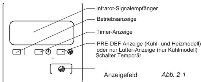
Diese Funktion dient zur temporären Steuerung der Anlage, falls Sie die Fernbedienung verlegt haben oder deren Batterien leer sind. Die beiden Betriebsarten AUTO und FORCED COOL können mit dem Schalter TEMPORARY am Anzeigefeld gewählt werden. Sobald Sie diesen Schalter drücken, arbeitet die Klimaanlage in der folgenden Betriebsart: AUTO, FORCED COOL, (COOLING TEST HEATING TEST,) OFF und zurück zu AUTO.
