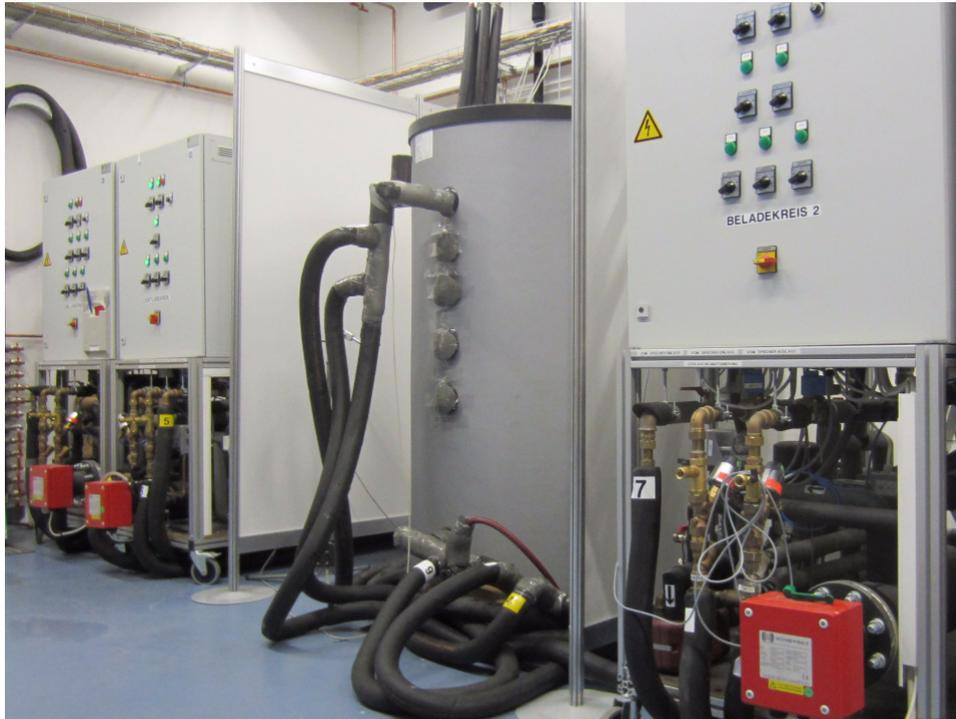
**Abb. 2-1:** Foto des Speichers Typ P800 PU im Prüflabor
